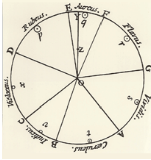
Dibujo original del modelo cromático de Newton. La proporción que corresponde a cada matiz es de acuerdo con el espacio que el mismo color ocupa en el espectro luminoso.
