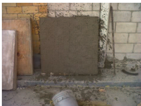
Muestra 3 con zampeo de cemento – arena. (Primera capa)
