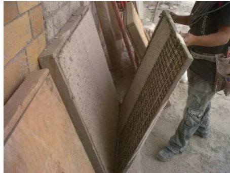
Vista de Muestra 3(reforzada con fibra de vidrio) con cuadrícula para revisión de fisuras. A cada 10 cms
