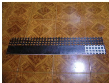
Trabajos de cortes sobre tiras de polietileno
