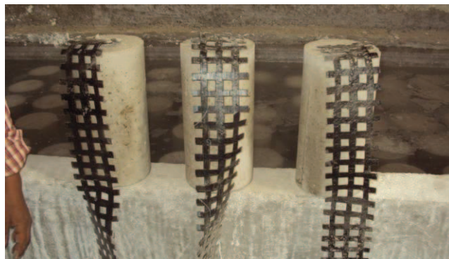
Imagen de los 3 cilindros el día 11 de enero para su inserción en la pileta de curado.
