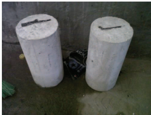
Vista de pileta cilindros con la tira de malla desprendida.
