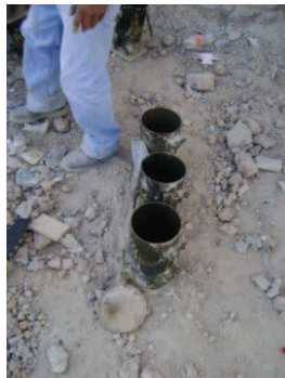
Cilindros de acero para elaboración de muestras de adherencia.
