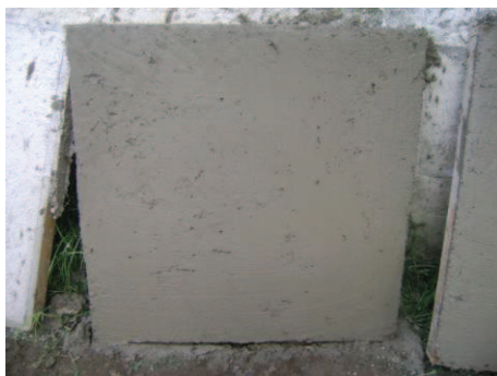
Muestra 1 con zampeo de cemento – arena (Primera capa)
