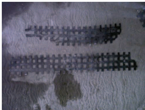
Fragmentos de tira de polietileno desprendidos de los cilindros del concreto sin hacer esfuerzo.
