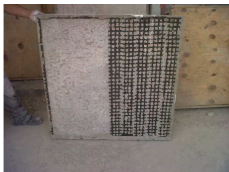
Vista de Muestra 3(reforzada con fibra de vidrio) con cuadrícula para revisión de fisuras. A cada 10 cms
