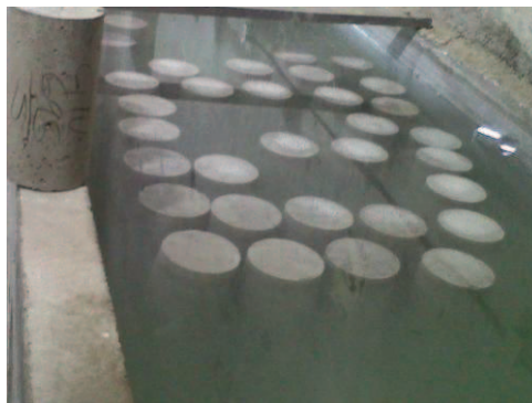
Vista de Pileta prestada por el laboratorio Lanc para inserción de cilindros para trabajos de curado.
