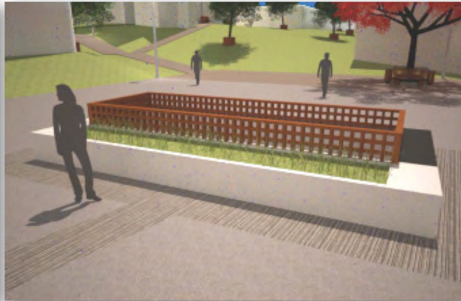
Salidas de ventilación de estacionamientos.
