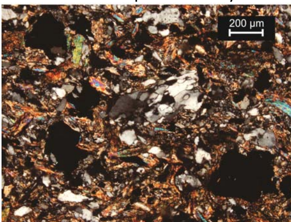
Fotomicrografía de lámina delgada de la muestra P4A12-01. Izquierda: Cuarzo policristalino con abundantes micas y matriz arcillosa. Derecha: Abundante cuarzo, con contactos suturados. Unidad Tecocoyunca Inferior.
