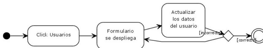
Figura 3.13: Representación del flujo de actualización de usuarios para interfaces gráficas
