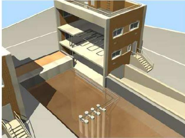
Figura 4.7 Interconexión activa – pasiva proyectada: Intercambiador vertical de geotermia y forjado de inercia
