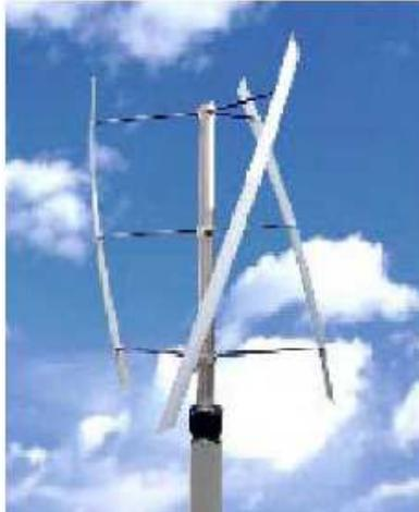
Figura 4.8 Aero generador vertical previsto
