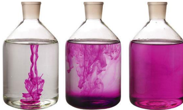
Figura 3.3 Representación del fenómeno de difusión en un volumen controlado. Difusión de permanganato de potasio en agua 36
