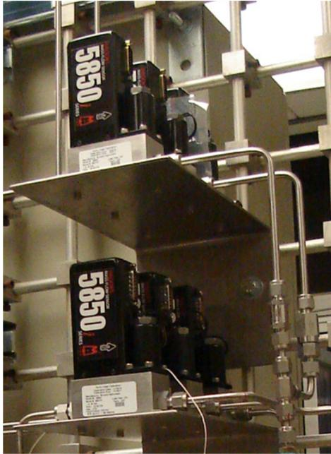
Figura 3-5 Controladores de Flujo Másico para los gases de proceso. Planta de micro reacción U-SCLAUS, Referencia interna IMP 2011.
