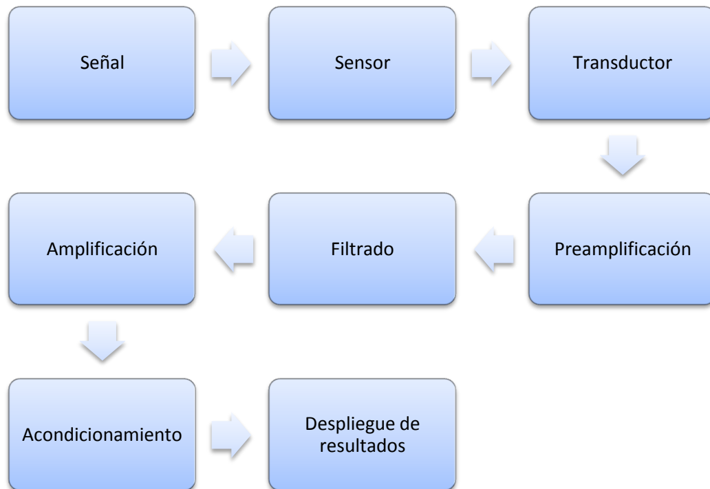
Figura 7: Esquema básico de un instrumento de medición
