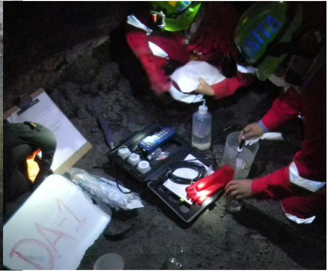
Figura 5-5 Medición de pH "in situ" con potenciómetro
