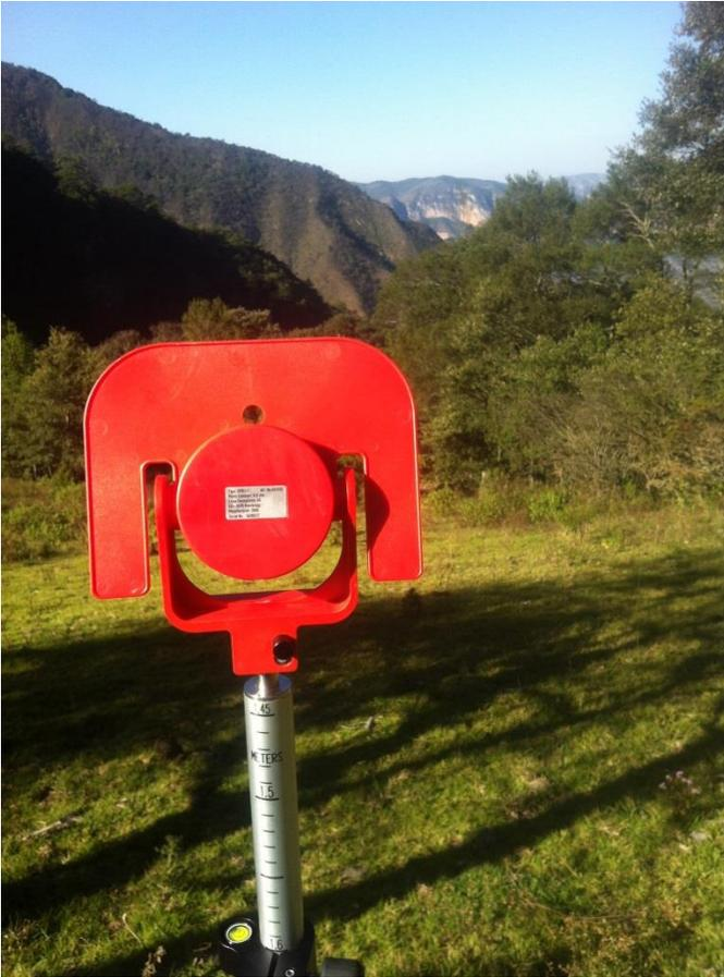
Figura 6-6 Estadal con prisma y visibilidad optima
