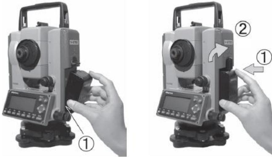
Figura 5-2 Instalación de batería (Pentax V-200 Quick Reference Guide)
