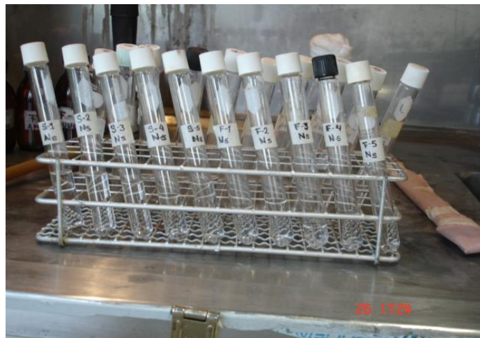
Imagen. VIII Tubos con medio específico para Nitrosomonas (Ns) listos para incubar
