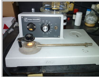
Figura 3.4. Aparato de Fisher-Johns para medir el punto de fusión de los tensoactivos
