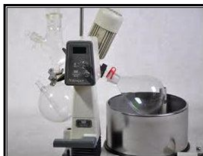
Figura 3.3. Rotavapor empleado en la síntesis de los tensoactivos desemulsificantes
