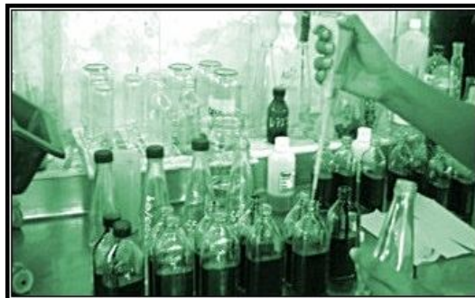
Figura 3.10. Dosificación a diferentes concentraciones de los productos deshidratantes a cada botella.
