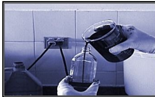
Figura 3.9. Vaciado de la emulsión A/P en cada uno de los frascos oblongos para la prueba de botella
