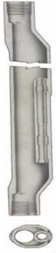
Figura 2.3 – Válvula de circulación tipo mandril
