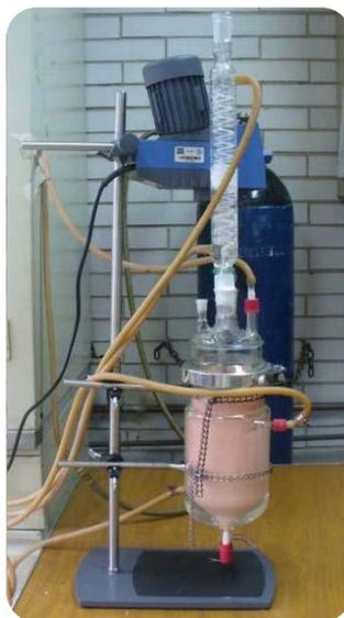
**Figura 2.** Reactor de cinco entradas en las cuales se conecta el flujo de nitrógeno, agua a 70 °C, serpentín de refrigeración y motor de agitación.
