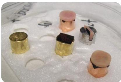
**Figura 4.** Colocación de las muestras en los portaobjetos.
