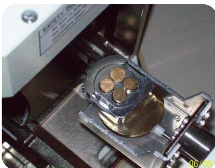
**Figura 6.** Colocación de los portaobjetos en la platina del microscopio.
