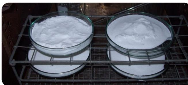
**Figura 3.** Partículas de PMMA en proceso de secado
