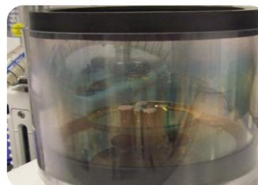
**Figura 5.** Ionización de las muestras con una capa de oro-paladio.
