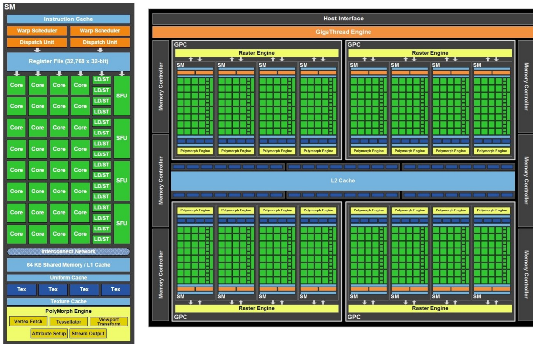
Figura 3.2: Esquema general de un SM en la arquitectura Fermi y forma de agrupar los componentes en su versión GF100.
