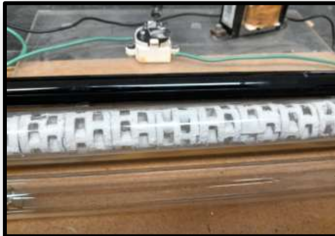
Figura 15: Diseño del dispositivo con tubos de cuarzo y lamparas germicidas y de luz negra.
