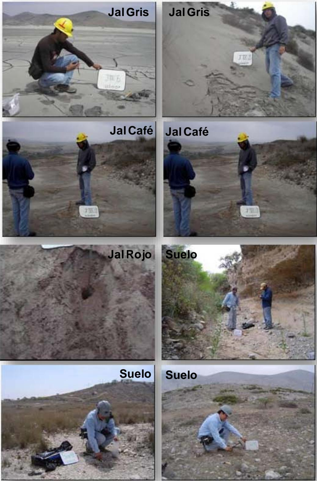
**Figura 4.4** Imágenes del muestreo de jales y suelos en la zona minera.
