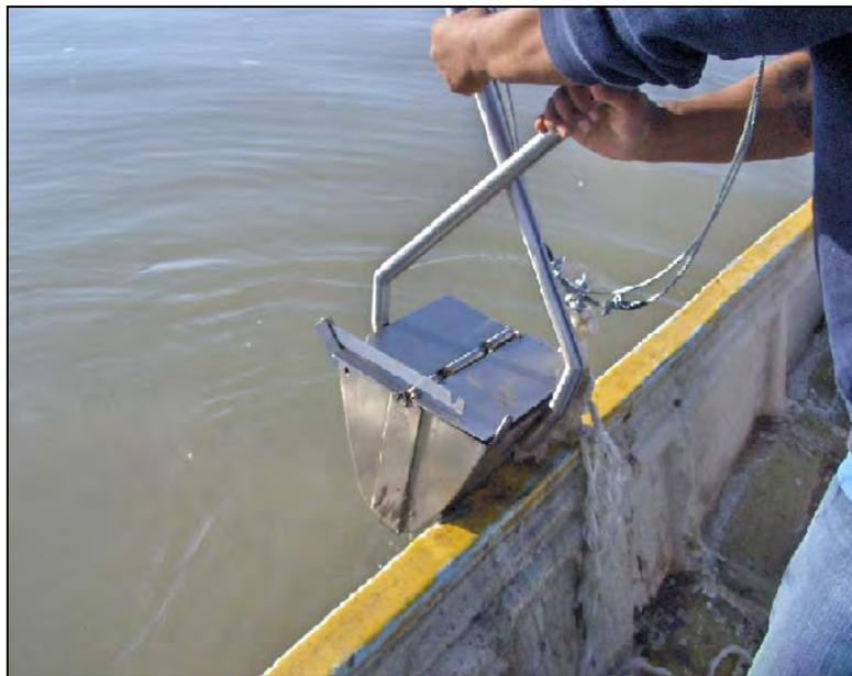
**10**Figura 4.3. Imagen de la draga tipo Van Veen utilizada para colectar la muestra de sedimento.
