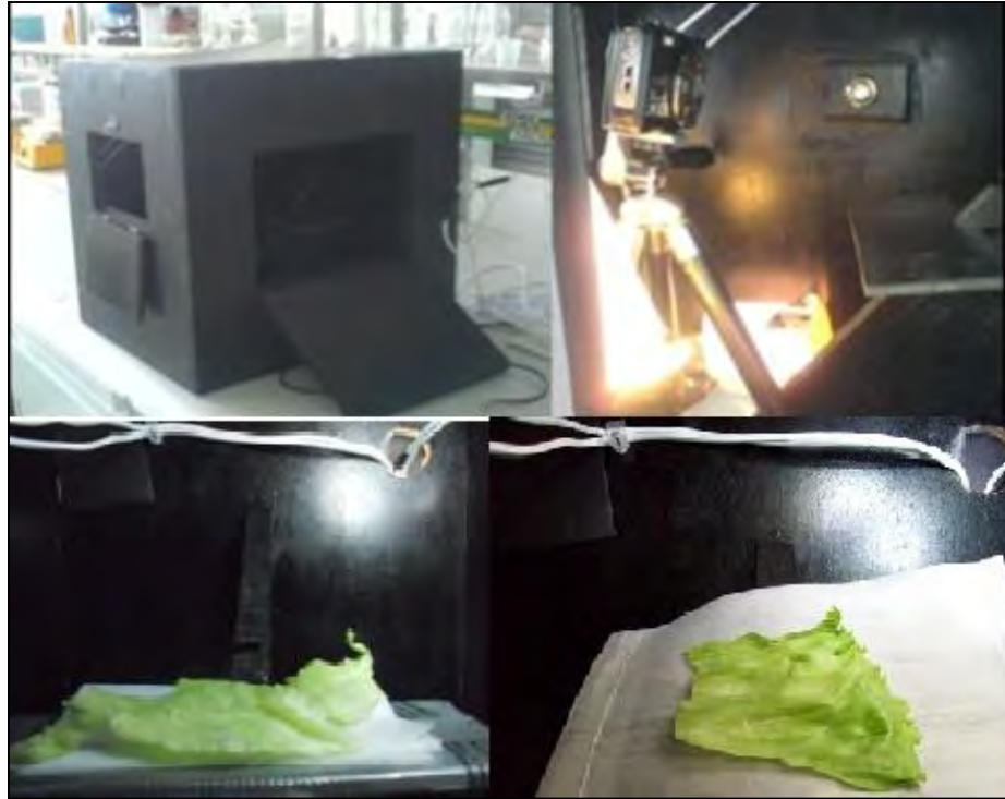
Figura 19. Adaptación del escenario oscuro para la medición del color.
