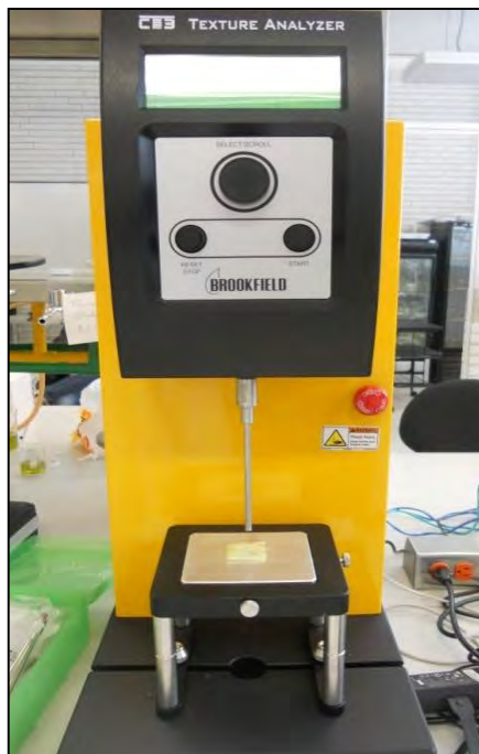
Figura 20. Texturómetro Brookfield® CT3 realizando prueba de punción.
