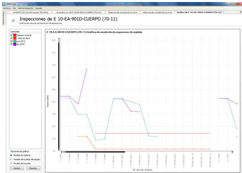
Figura 4.17 Gráfica de medición de espesores de niplería del cuerpo de la unidad de control EA-901 D en el SIMECELE.
