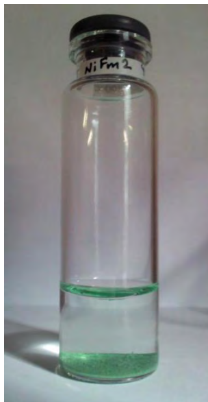
Figura 14. Polvo cristalino del fumarato de níquel sin presencia del gel. Condiciones de reacción: T=100^{\circ}\text{C} , tiempo=3 días y relación estequiométrica= 4:3
