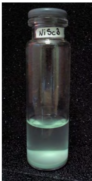
Figura 15. NiSc 3 (polvo cristalino). Condiciones de reacción: T=100°C, tiempo=3 días y relación estequiométrica=5:3
