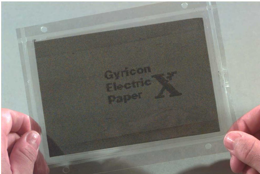
Ejemplo de la tinta electrónica de Gyricon 16
