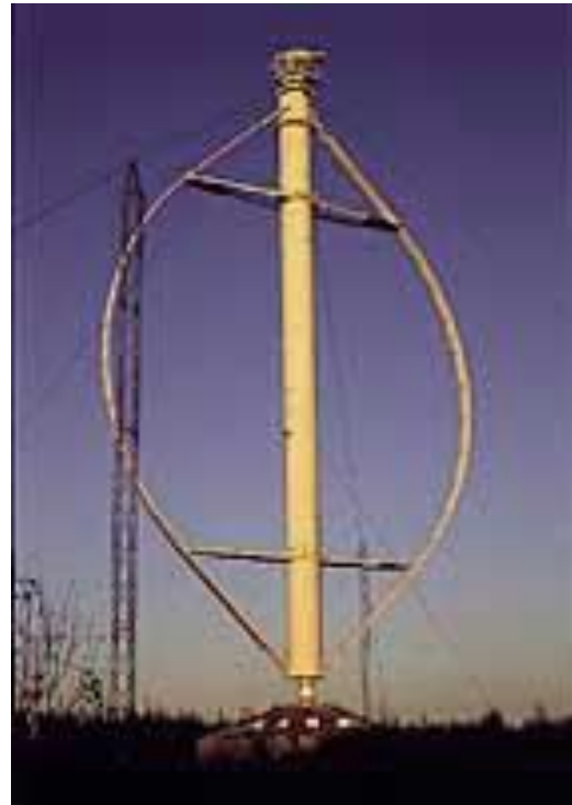
Figura 2.5 Aerogenerador de eje vertical
