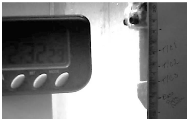
Figura 4.4. Procedimiento para indicar la posición de cada termopar en las imágenes, para un experimento aleatorio.
