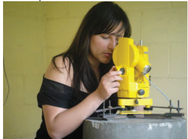
Figura. 3.1.33. Teodolito DI-FLUX ZEISS A-20 con el círculo en dirección al Oeste y el sensor Fluxgate con dirección hacia-abajo.
