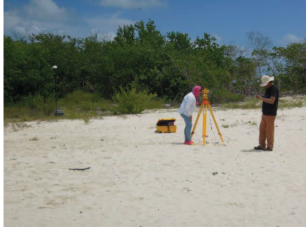
Figura 3.1.36. Estación magnética de repetición de Puerto Juárez 2013, medición de las tres componentes de campo magnético DIF simultáneamente.
