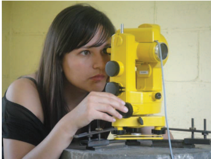
Figura. 3.1.26. Teodolito DI-FLUX ZEISS A-20 cuasi-nivelado con el sensor Fluxgate en dirección hacia-arriba.
