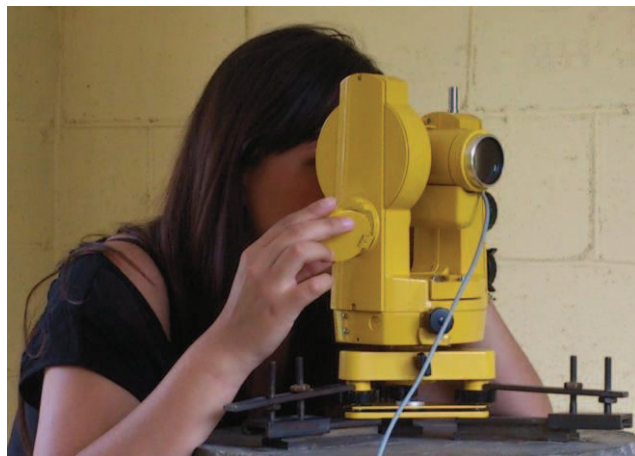
Figura. 3.1.27. Teodolito DI-FLUX ZEISS A-20 cuasi-nivelado con el sensor Fluxgate en dirección hacia-abajo.
