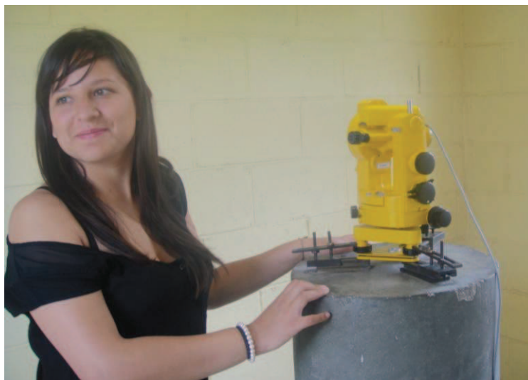
Figura. 3.1.25. Teodolito DI-FLUX ZEISS A-20 cuasi-nivelado.
