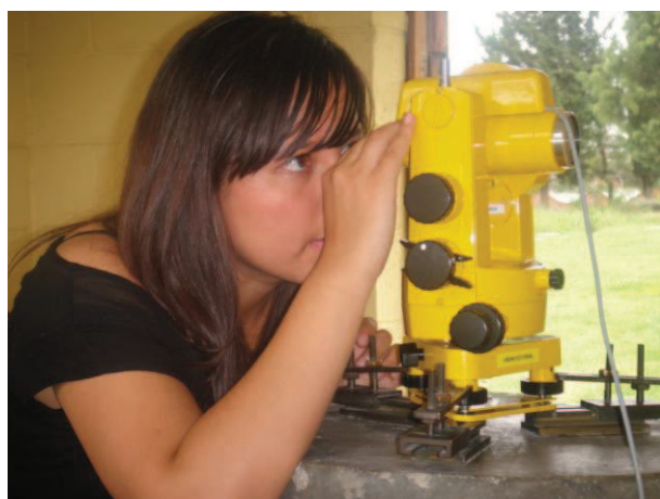
Figura. 3.1.28. Teodolito DI-FLUX ZEISS A-20 con el círculo en dirección al Norte y el sensor Fluxgate con dirección hacia-arriba.
