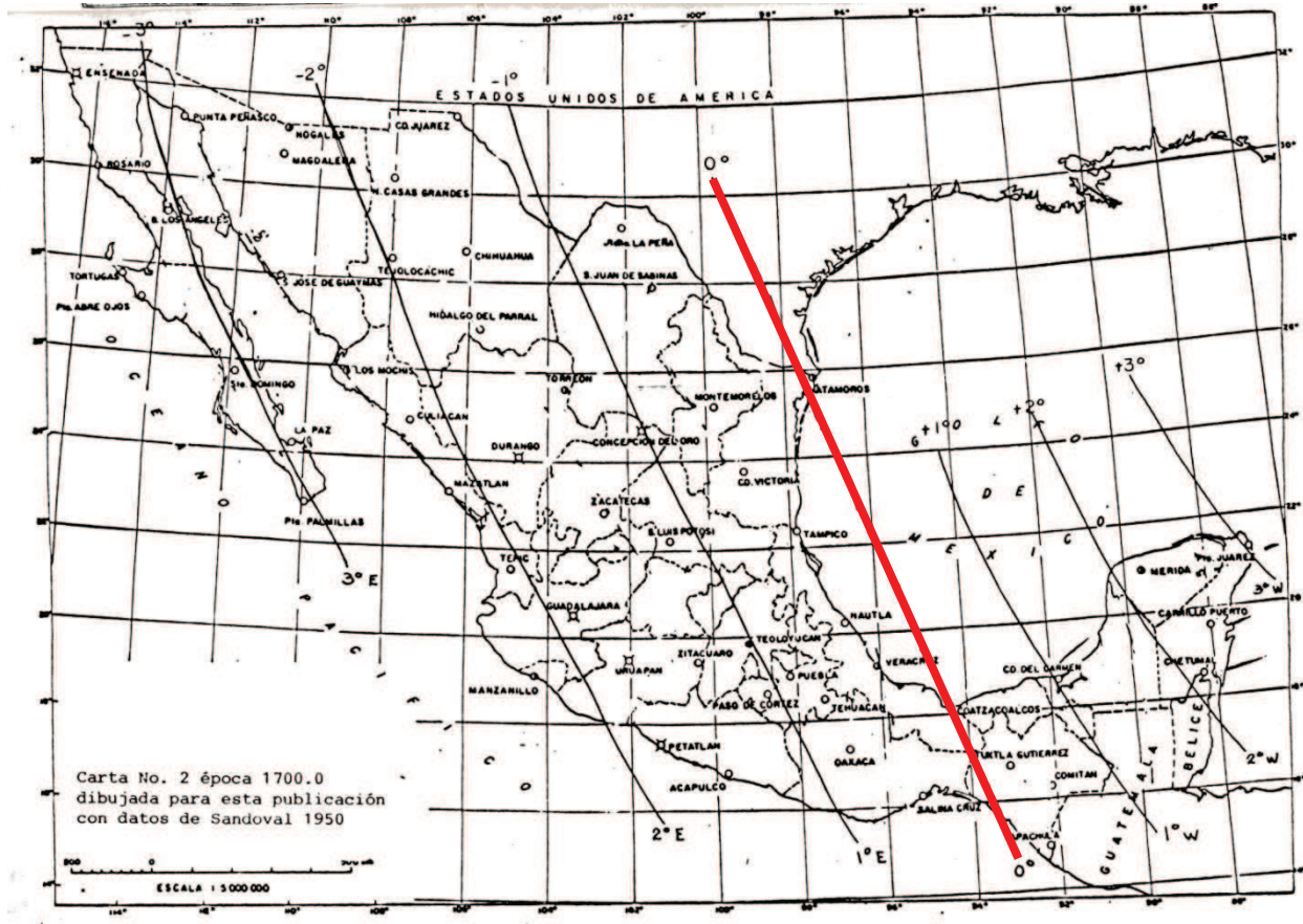
Figura 1.2.2 Carta Magnética de la Republica Mexicana construida con datos de Sandoval 1950 correspondiente a la época 1700.0 (Cañón, 1989).
