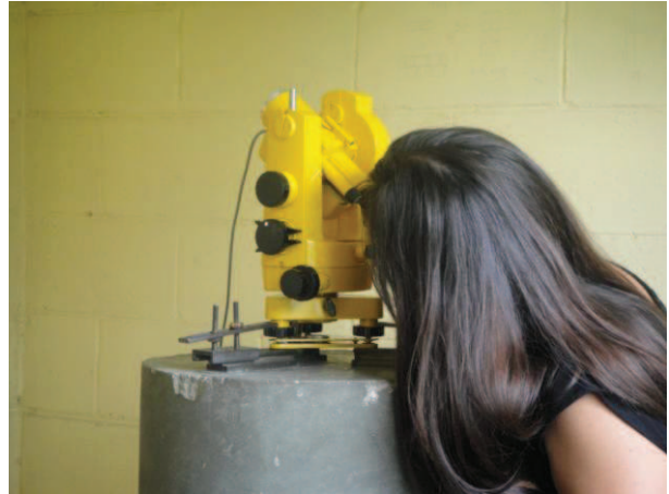
Figura. 3.1.34. Teodolito DI-FLUX ZEISS A-20 con el círculo en dirección al Este y el sensor Fluxgate con dirección hacia-abajo.
