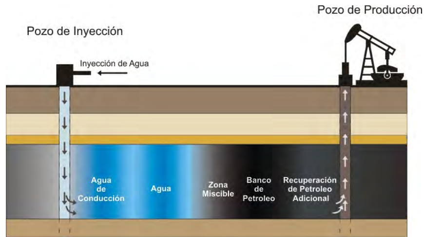
Figura 3.9: Inyección de agua en yacimientos petroleros.
