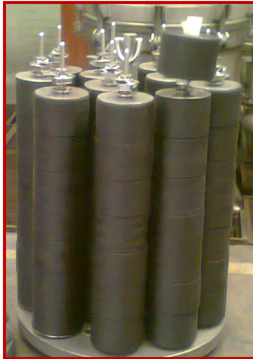
Figura 10: Hilos después del proceso de teñido con el colorante negro Terasil SRL.
