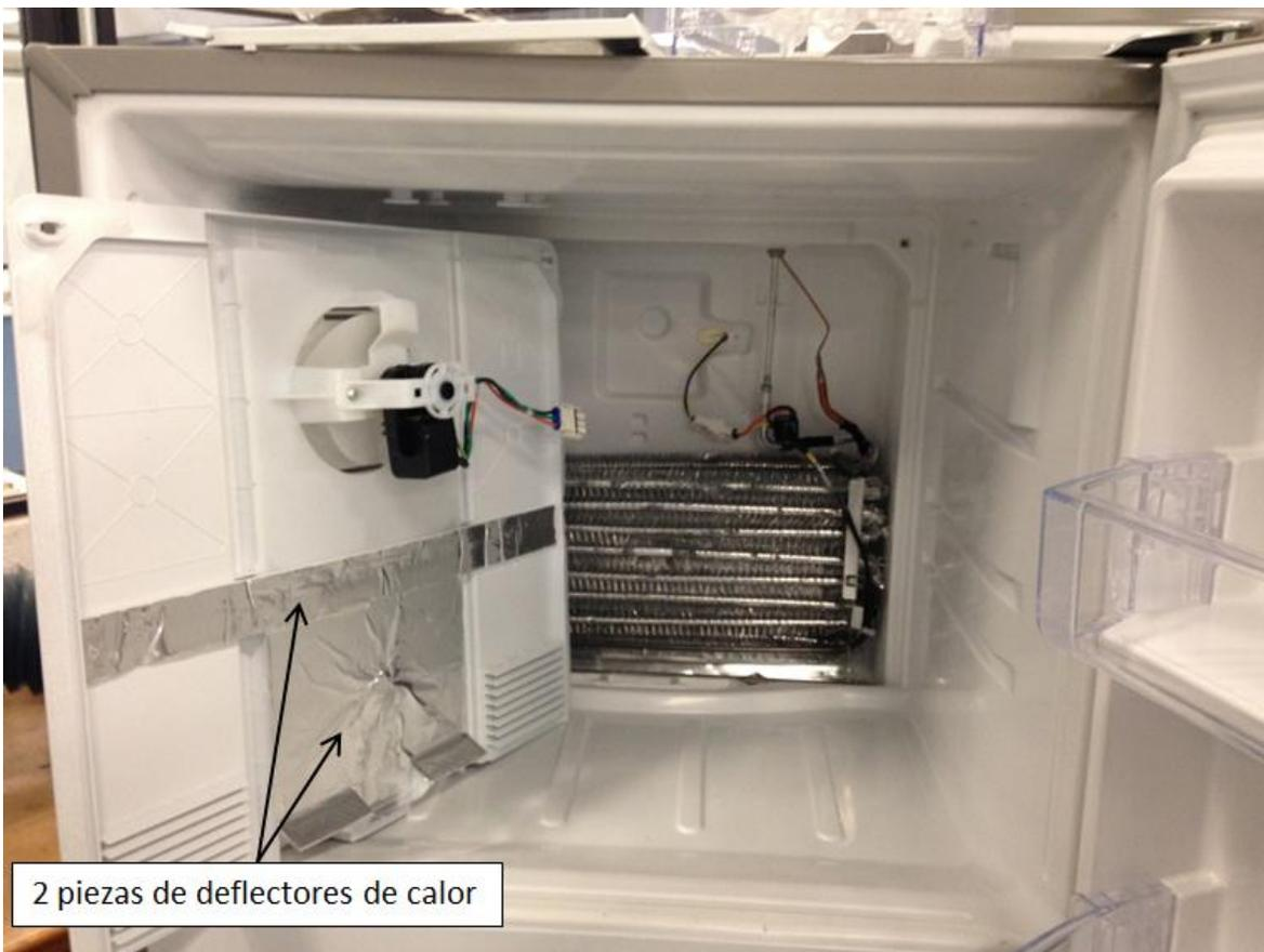
**Fig. 41** Interior del congelador del refrigerador de línea base con la cubierta evaporador desensamblada. Se muestra el evaporador al fondo y la cara trasera de la cubierta evaporador. Se muestran las dos piezas de deflectores de calor que se eliminan con la propuesta del sistema de deshielo por aspersión de agua.
