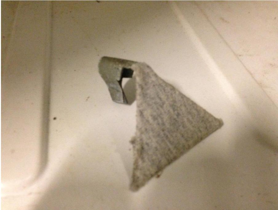
**Fig. 12** Imagen del aspersor diseñado, con lámina de metal y tela, para el refrigerador prototipo con deshielo con agua.
