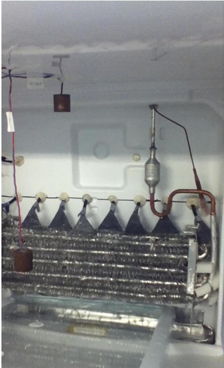
**Fig. 20** Imagen del sistema de deshielo por aspersión de agua después de 120 segundos de funcionamiento. Se muestra como se ha removido por completo la escarcha de la superficie del evaporador.
