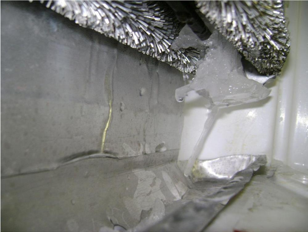
**Fig. 33** Imagen de bloques de hielo en crecimiento. El hielo se ubica debajo del evaporador del refrigerador prototipo con sistema de deshielo por aspersión de agua.
