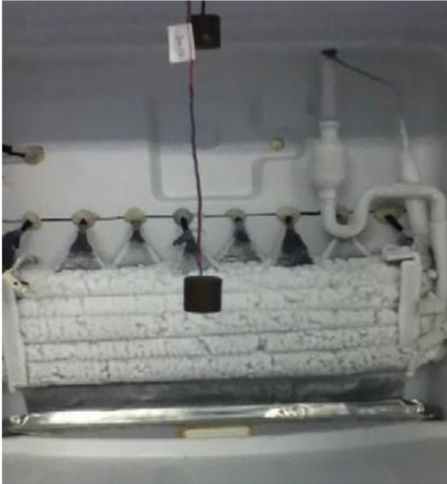
**Fig. 17 Vista frontal del evaporador completamente cubierto por escarcha. El sistema de deshielo por aspersion de agua se encuentra apagado y también cubierto parcialmente por escarcha.**
