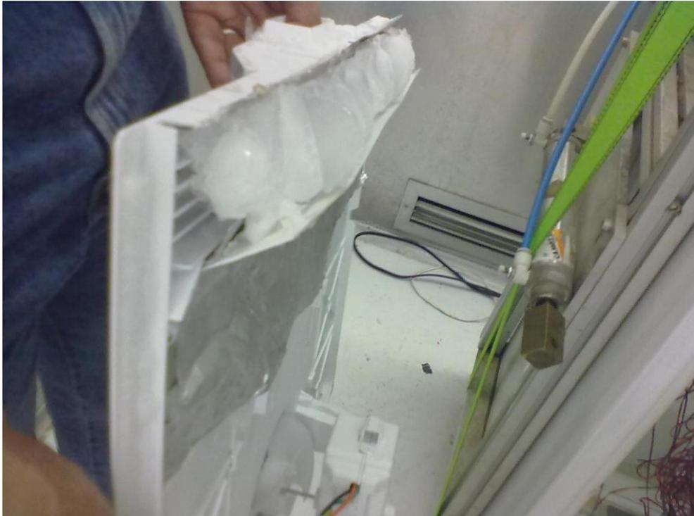
**Fig. 32 Tapa evaporador desensamblada y con presencia de bloques de hielo en la superficie trasera del mismo. El hielo que se observa obstruye el flujo de aire al interior del congelador.**
