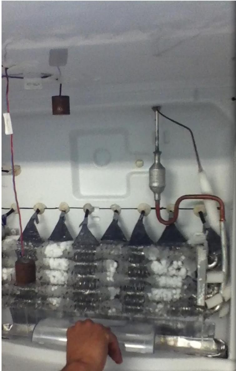
**Fig. 19** Imagen del sistema de deshielo por aspersión de agua después de 60 segundos de funcionamiento. Se muestra como se ha removido más del 50% de la escarcha de la superficie del evaporador.
