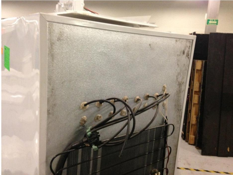
**Fig. 7** Ubicación del distribuidor (*manifold*) con cabezal de  $\frac{1}{2}$ " de diámetro a la entrada y ocho bifurcaciones con manguera de  $\frac{3}{16}$ " de diámetro. Éste se encuentra en la parte alta del respaldo del refrigerador.
