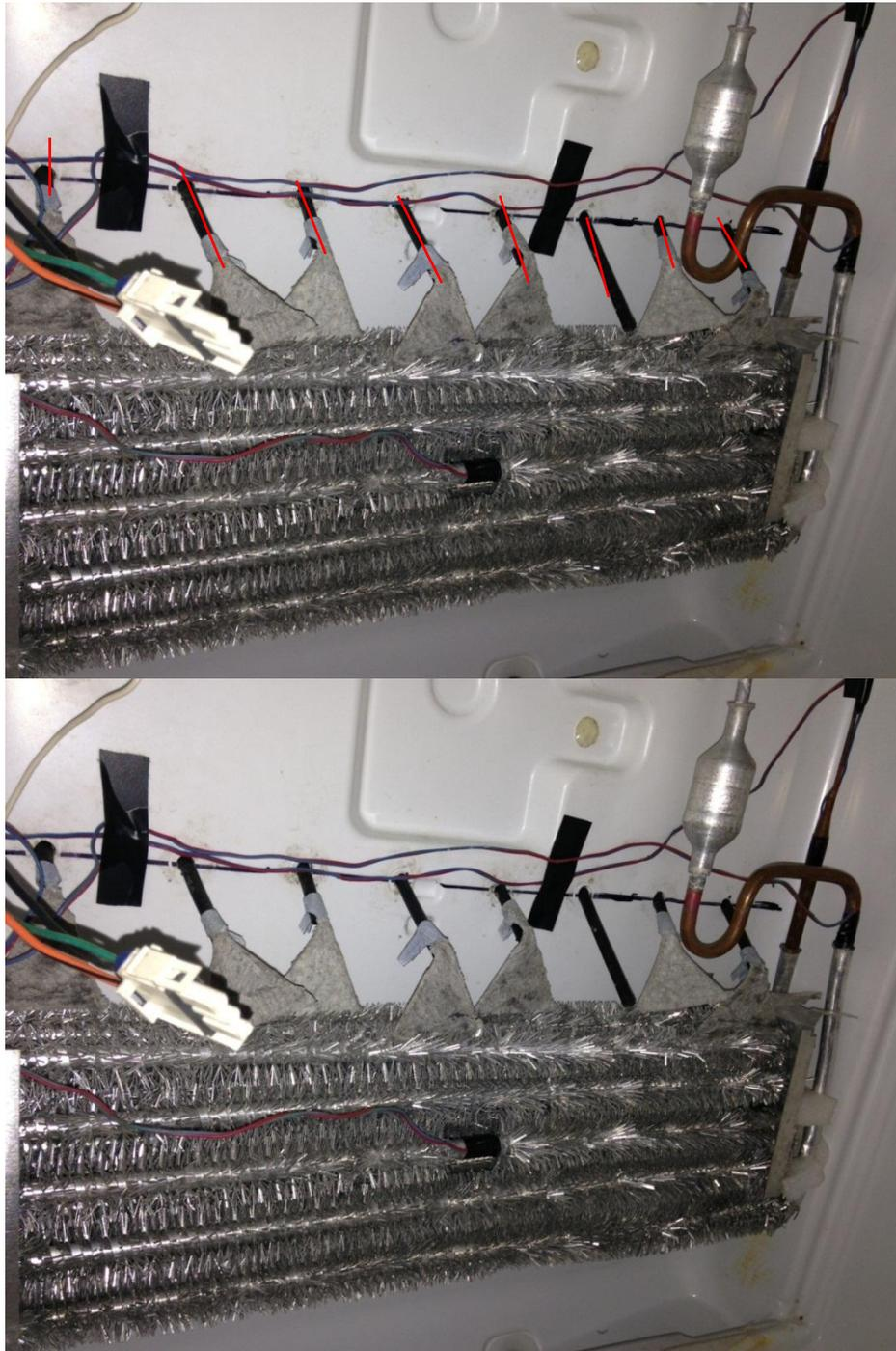
**Fig. 38** Se muestra una imagen del interior del refrigerador prototipo. En la imagen de arriba se muestra en color rojo las partes sustituidas por el riel distribuidor. En la parte de abajo se muestra la fotografía original.
