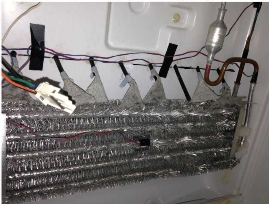
**Fig. 13** Imagen del sistema de aspersión para el prototipo con deshielo con agua. Se muestran los aspersores diseñados que evitan el bloqueo con agua congelada.
