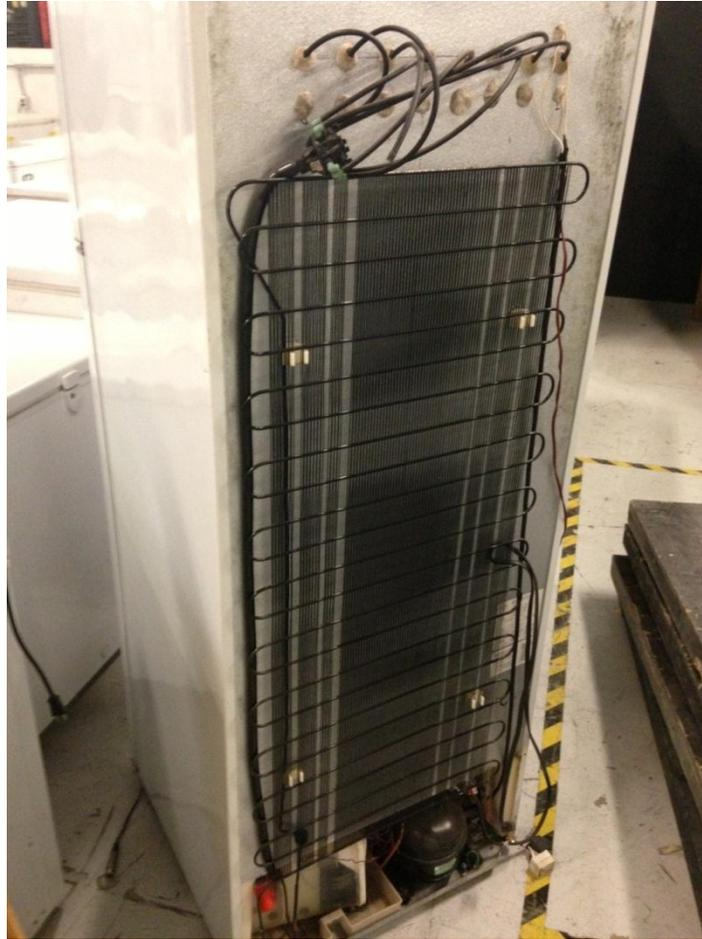
**Fig. 8 Imagen del respaldo completo del refrigerador prototipo con parte del sistema de aspersión de agua para descongelar el evaporador.**
