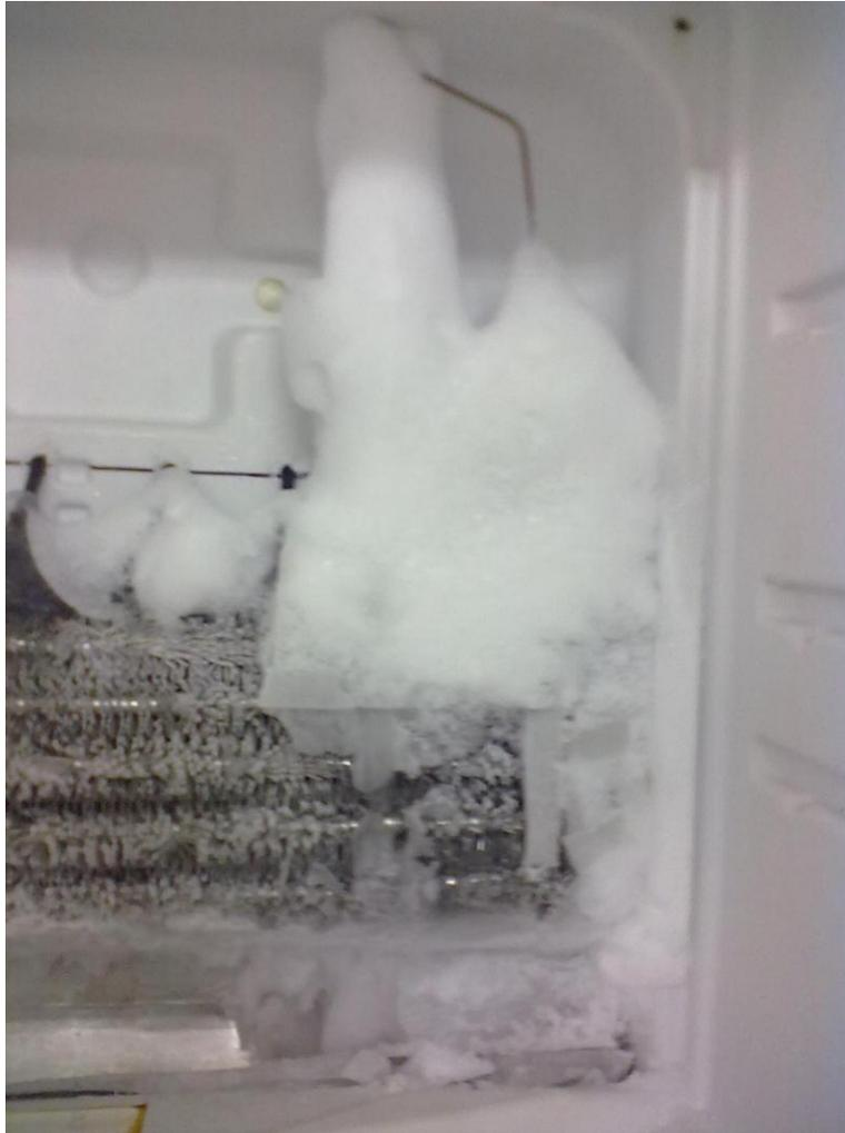
**Fig. 36** Se muestra el evaporador al haber finalizado otra prueba de uso extremo. Nuevamente se perciben bloques de hielo debajo del evaporador así como exceso de escarcha en los costados y en la parte superior del componente.
