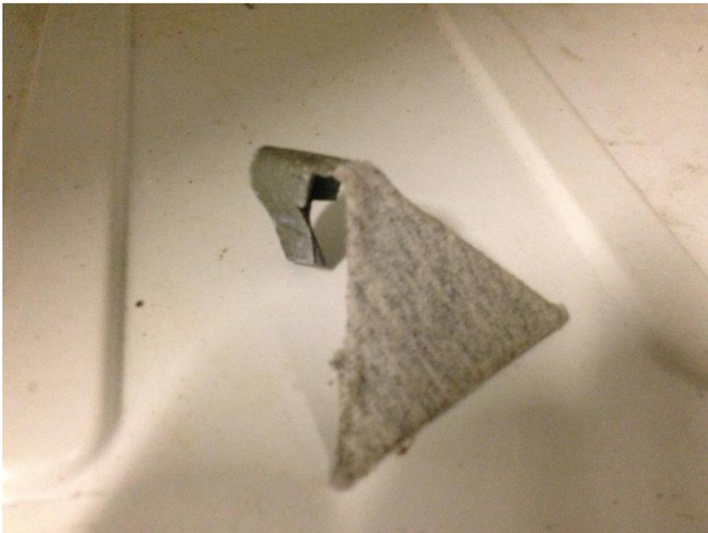
**Fig. 39** Imagen de la aleta triangular con recubrimiento de tela fabricada para el prototipo con deshielo por aspersión de agua.
