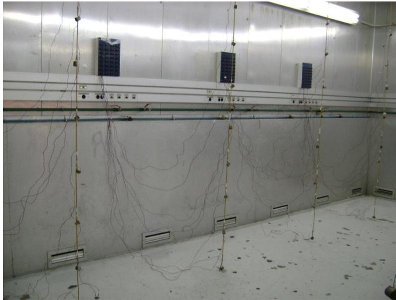
**Fig. 22** Vista interna de una de las cámaras térmicas. En la pared se aprecian tres de las ocho estaciones de prueba que se tienen habilitadas con capacidad de medir simultáneamente hasta 32 temperaturas y variables eléctricas de cada refrigerador bajo prueba.
