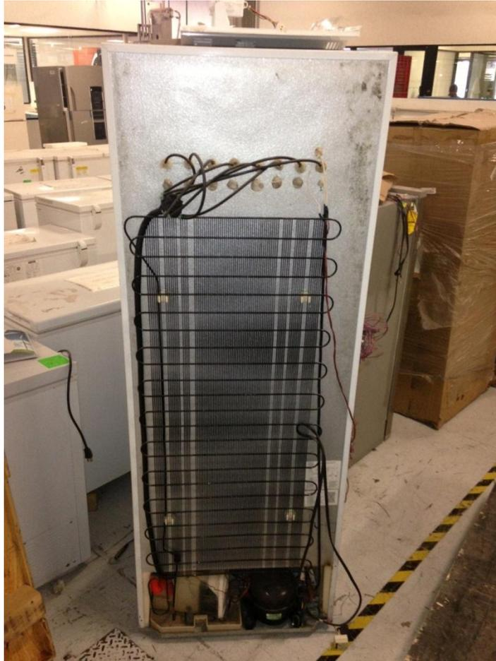
Fig. 11 Imagen del respaldo completo del refrigerador prototipo.
