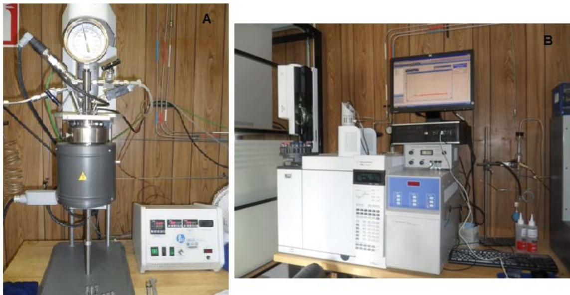
Figura 2.7. Reactor tipo batch para reacciones de hidrodesulfuración (A) y sistema de cromatografía de gases (B).
