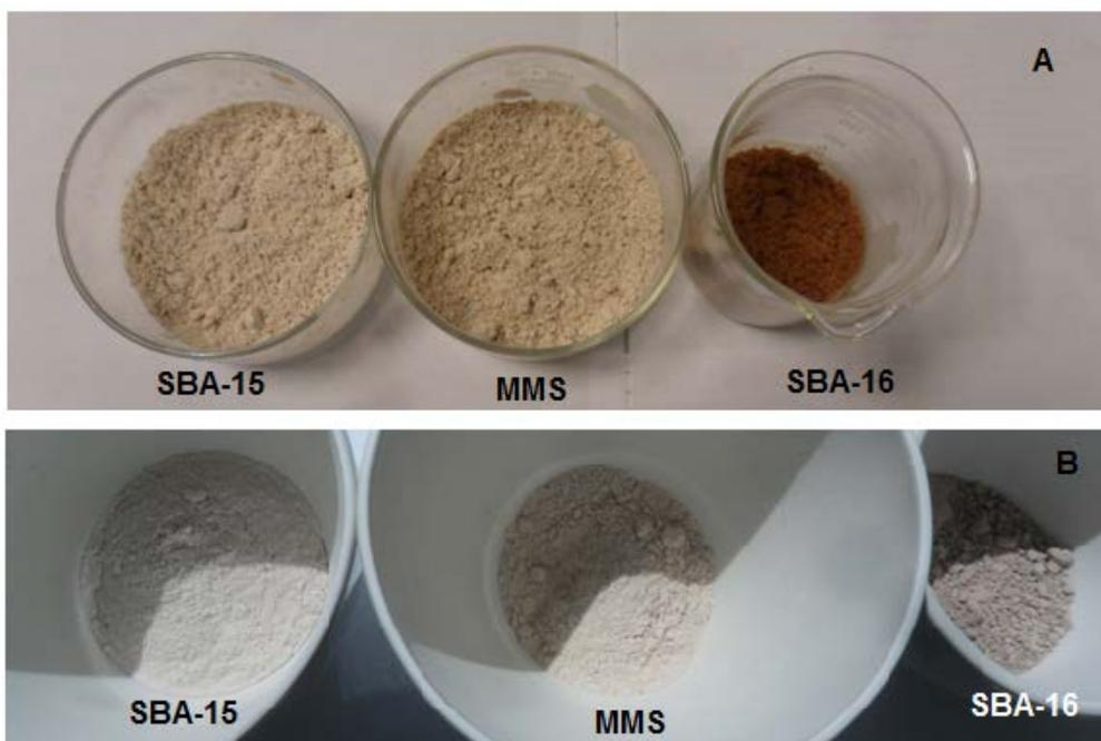
Figura 2.5. Apariencia de catalizadores impregnados (A) y calcinados (B).
