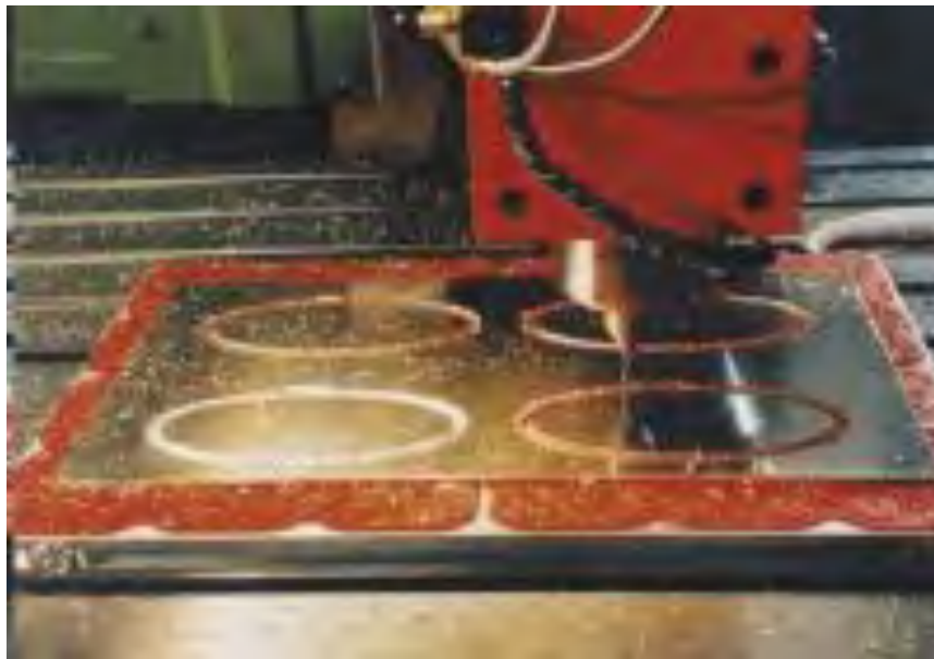
Figura 4.3: Una pieza plana detenida por vacío.
