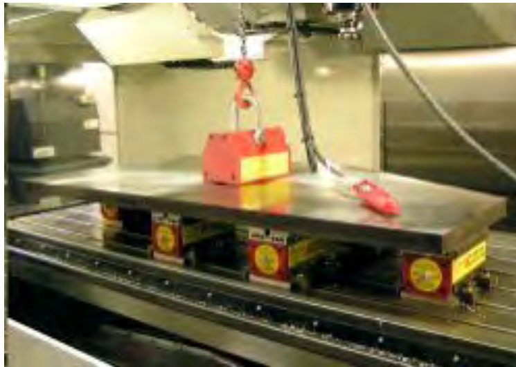
Figura 4.6: Un arreglo de cuatro prensas magnéticas sosteniendo una placa de acero lista para maquinarse. Se puede ver otro electromagneto acoplado a una pluma para mover piezas pesadas.
