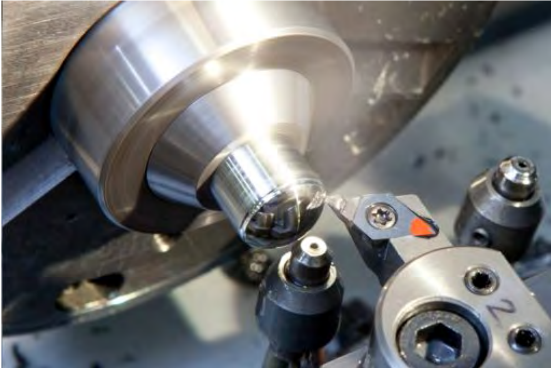
Figura 2.1: Maquinado de precisión en torno para el molde de un lente de contacto. Los moldes para inyección de plástico o lentes de contacto son de las aplicaciones principales del maquinado de precisión.
