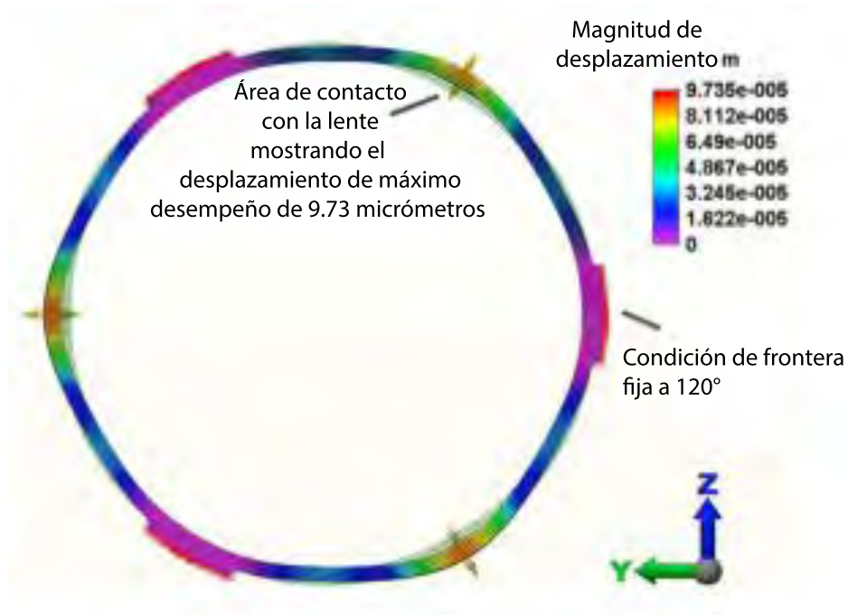
Figura 3.8: Ejemplo de soporte radial bajo el esfuerzo de los tornillos que jalan las muelles en tracción.
