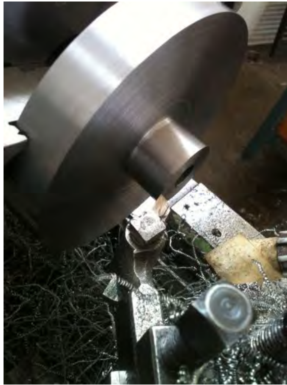
Figura 4.9: El MUAC montado en el torno del taller mecánico de precisión en sus últimas etapas de fabricación.
