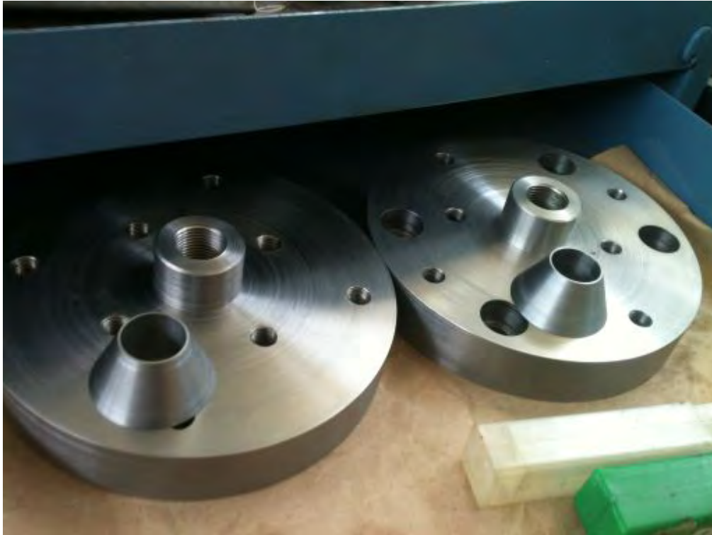
Figura 4.10: Los dos MUACs terminados con sus respectivos conos de auto centrado. El ejemplar de la derecha está provisto con barrenos y cajones para su montura en la bancada de la fresadora.
