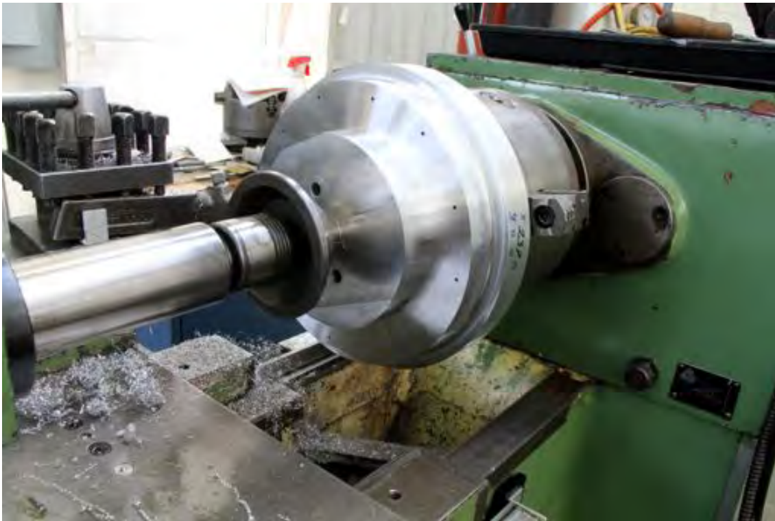
Figura 6.2: Celda cámara roja C1 montada sobre el torno para ajusta el diámetro exterior al tamaño justo de la interfaz (ver figura 6.3).
