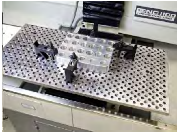
Figura 4.4: Un tocho fijado a la bancada de trabajo por stops y tornillos.
