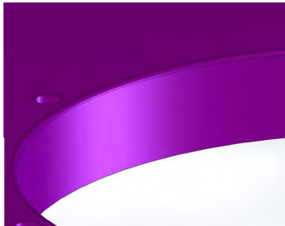
Figura 5.22: Detalle de corte interior, notesé el mate en la parte superior e inferior. Estos cortes se deben hacer en la CNC.
