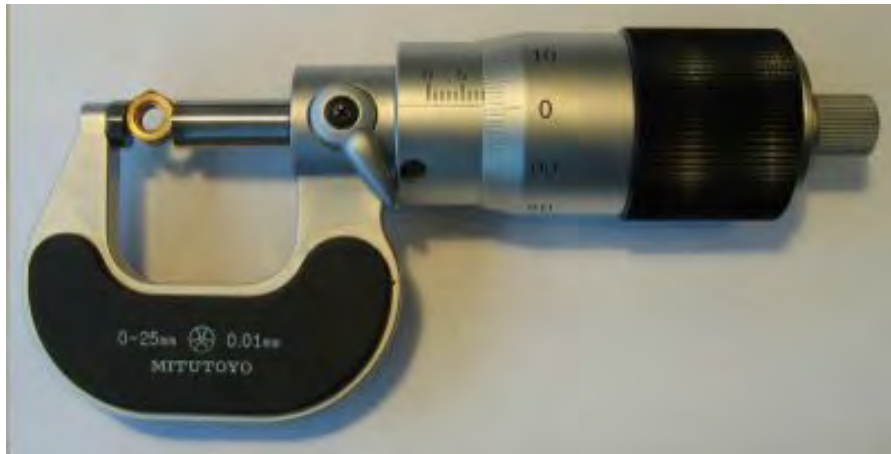
Figura 2.5: Un micrómetro de exteriores. Este tipo de instrumento, como su nombre lo indica, es capaz de medir hasta micrómetros.
