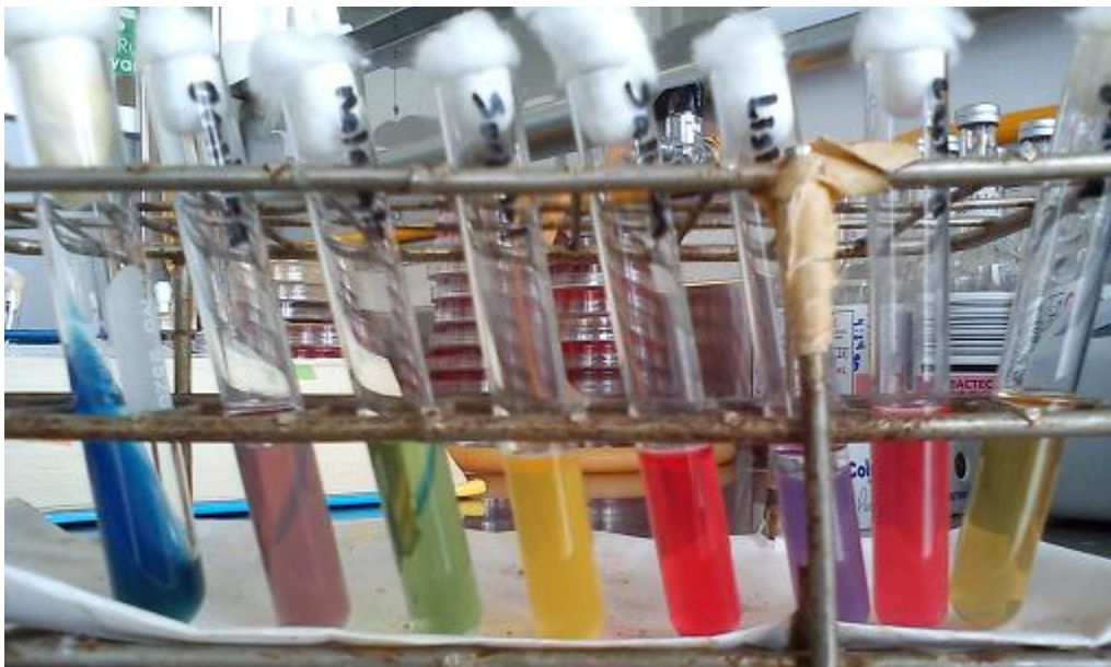
Fig. 3. Pruebas bioquímicas convencionales en tubo. De izquierda a derecha: Citrato, Ornitina descarboxilasa, Malonato, Sorbitol, Salicina, Lisina descarboxilasa, Lactosa y Arginina descarboxilasa.
