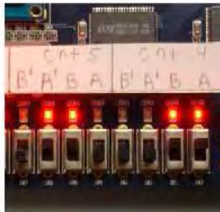
Figura A.3: Los interruptores determinan la coincidencia que es contada. En este caso el interruptor 4 contará las coincidencias de AB y el contador 5 las coincidencias de A'B.
