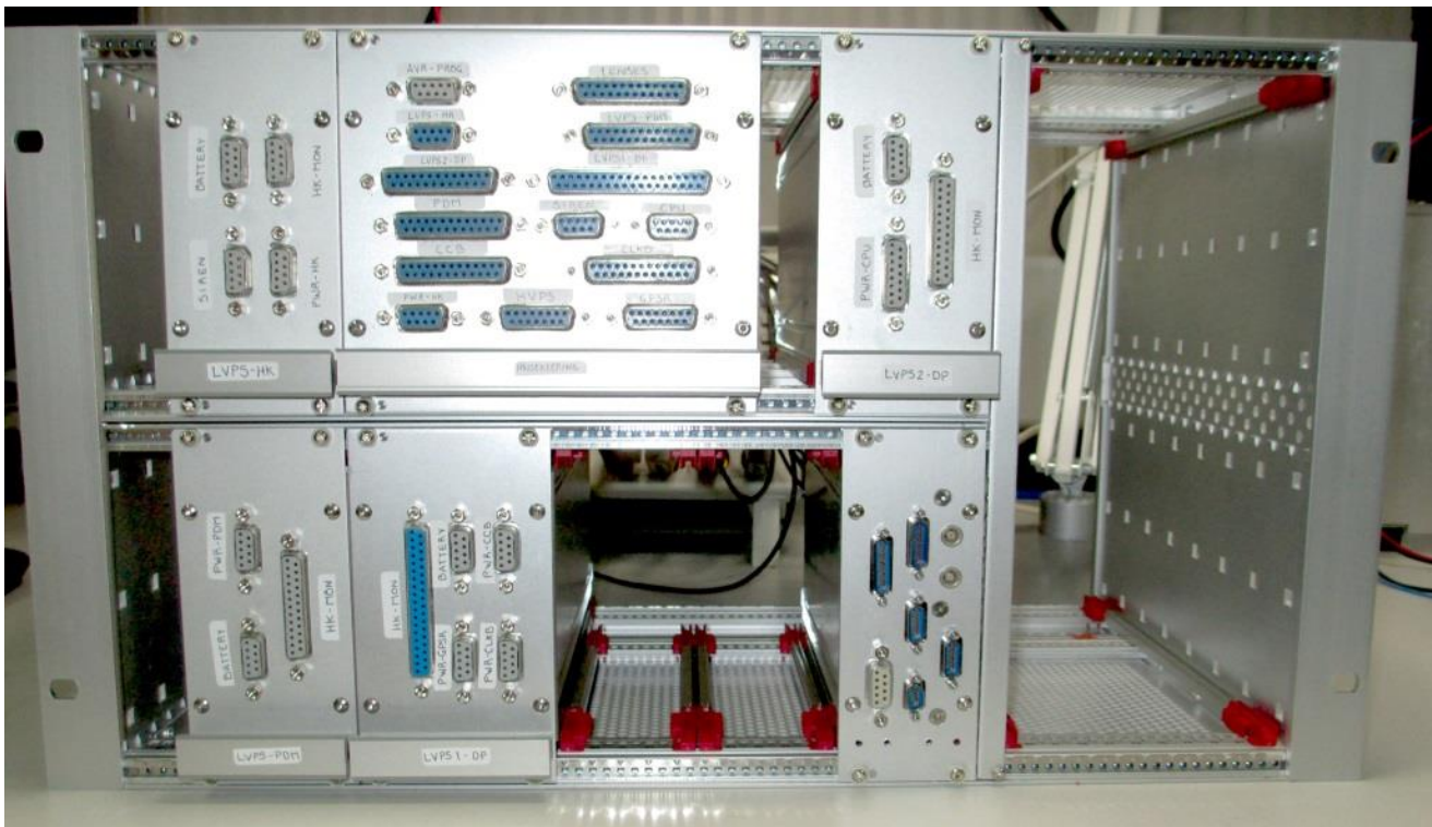
Figura 5.3. Housekeeping y LVPS montadas en rack de DP.
