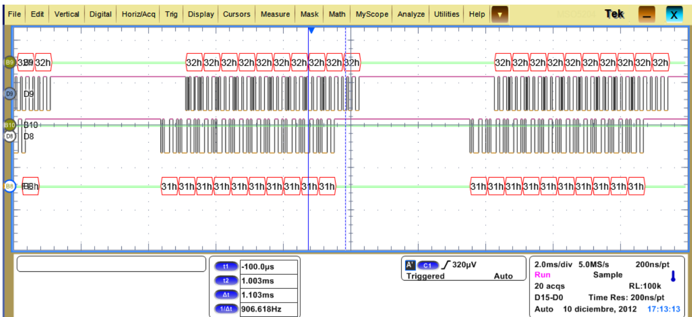
Figura 3.30. Prueba de comunicación full-duplex .
