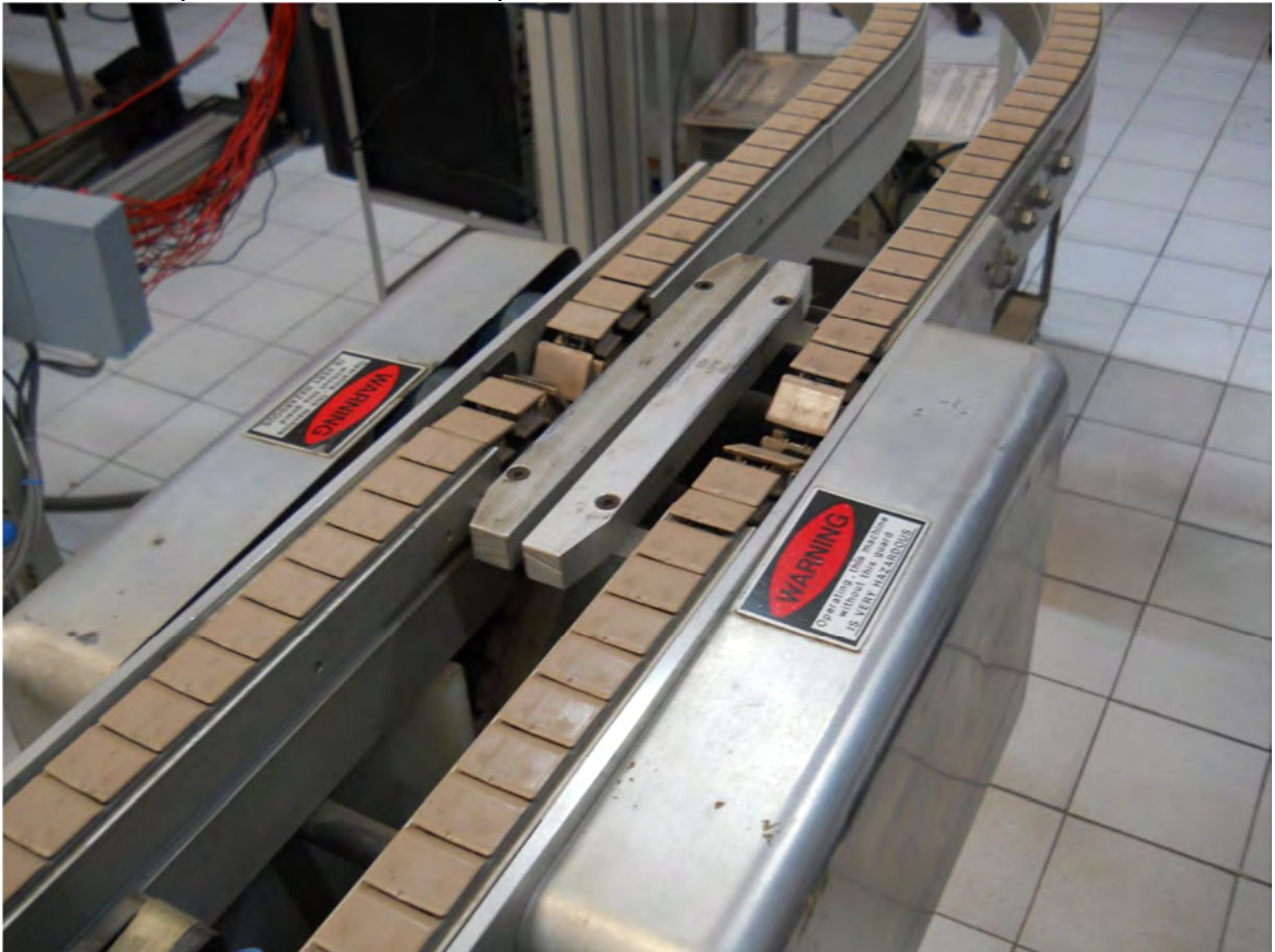
Figura 5.5 Banda transportadora ESHED ROBOTEC
