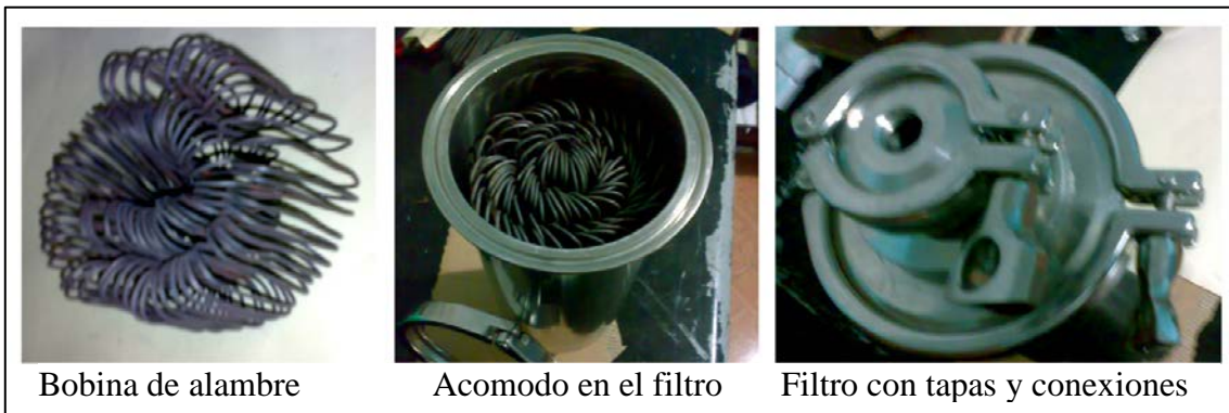
Figura 4.4 Filtro para quitar el ácido sulfhídrico
