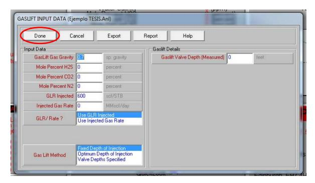
La profundidad de la válvula es de cero porque aun no conocemos a que profundidad va a quedar. Una vez que se capturan todos los datos de nuevo se selecciona "Done".
