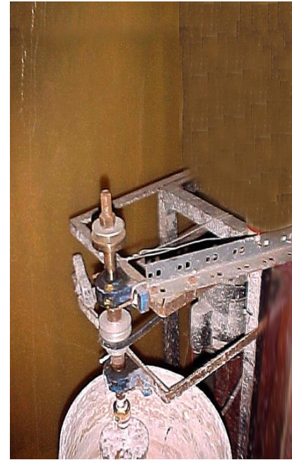
Fig. 3 Licuadora adaptada para reconvertir papel en pulpa
