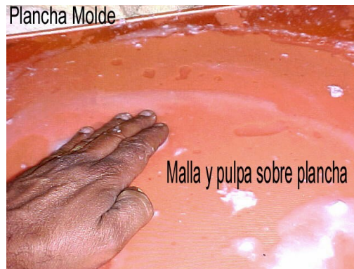
Imagen de la malla sobre la plancha molde en una acción de desalojo de aire que pudiera quedar atrapado entre la plancha y el papel.
