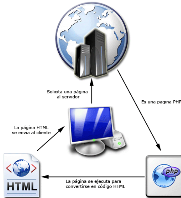
Figura 2.3.1 Diagrama de funcionamiento de PHP.
