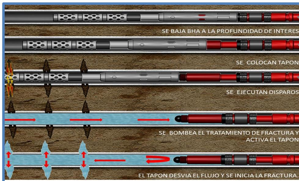
Figura 5.8. La figura explica el funcionamiento de un tapón mecánico en operación.
