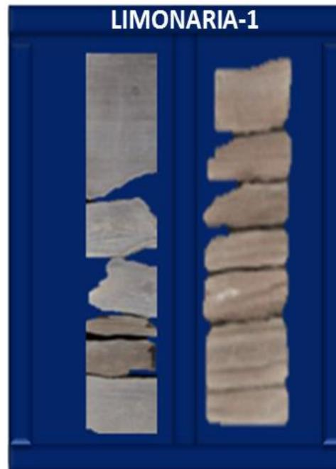
**Figura 3.10.** Núcleo de la formación Pimienta de aceite en lutitas del pozo Limonaria-1.
