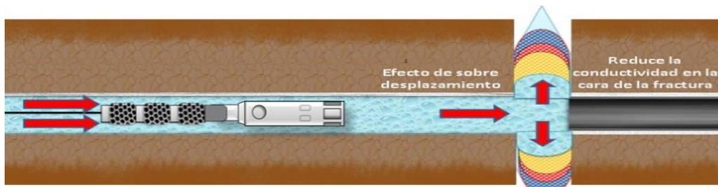
**Figura 5.11.** El efecto de sobre desplazamiento reduce la conductividad en la cara de la fractura.
