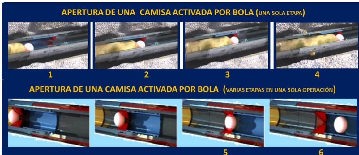
**Figura 5.17** Apertura de camisas activadas por bola para una o varias etapas en una terminación en OHMS.
