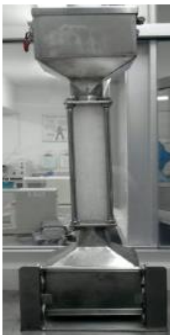
Figura 15. Equipo para medir el volumen del Bagel (Medidor de pan)
