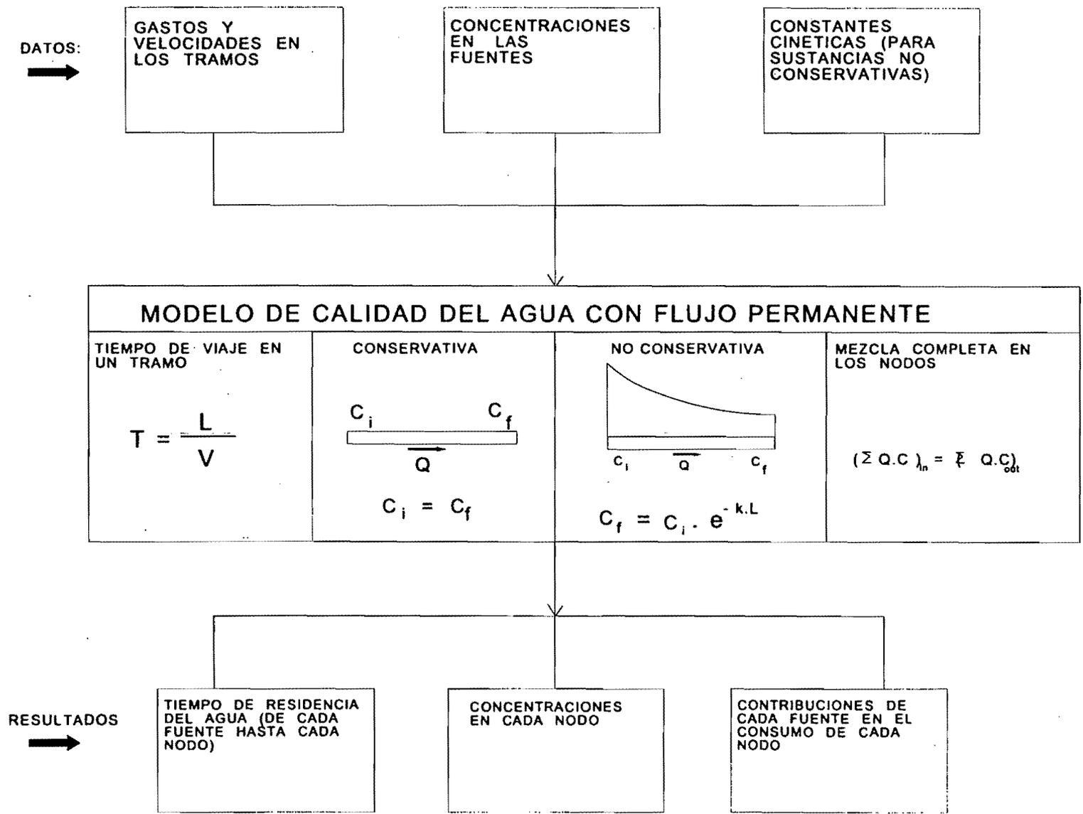
Figura 5.4. Modelo de flujo y concentración permanente
