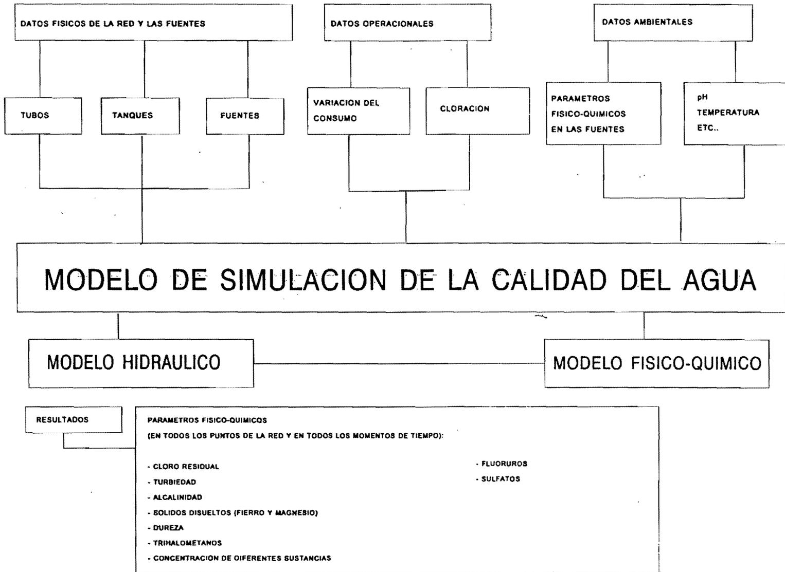
Figura 5.6. Esquema general del modelo de simulación de calidad del agua.
