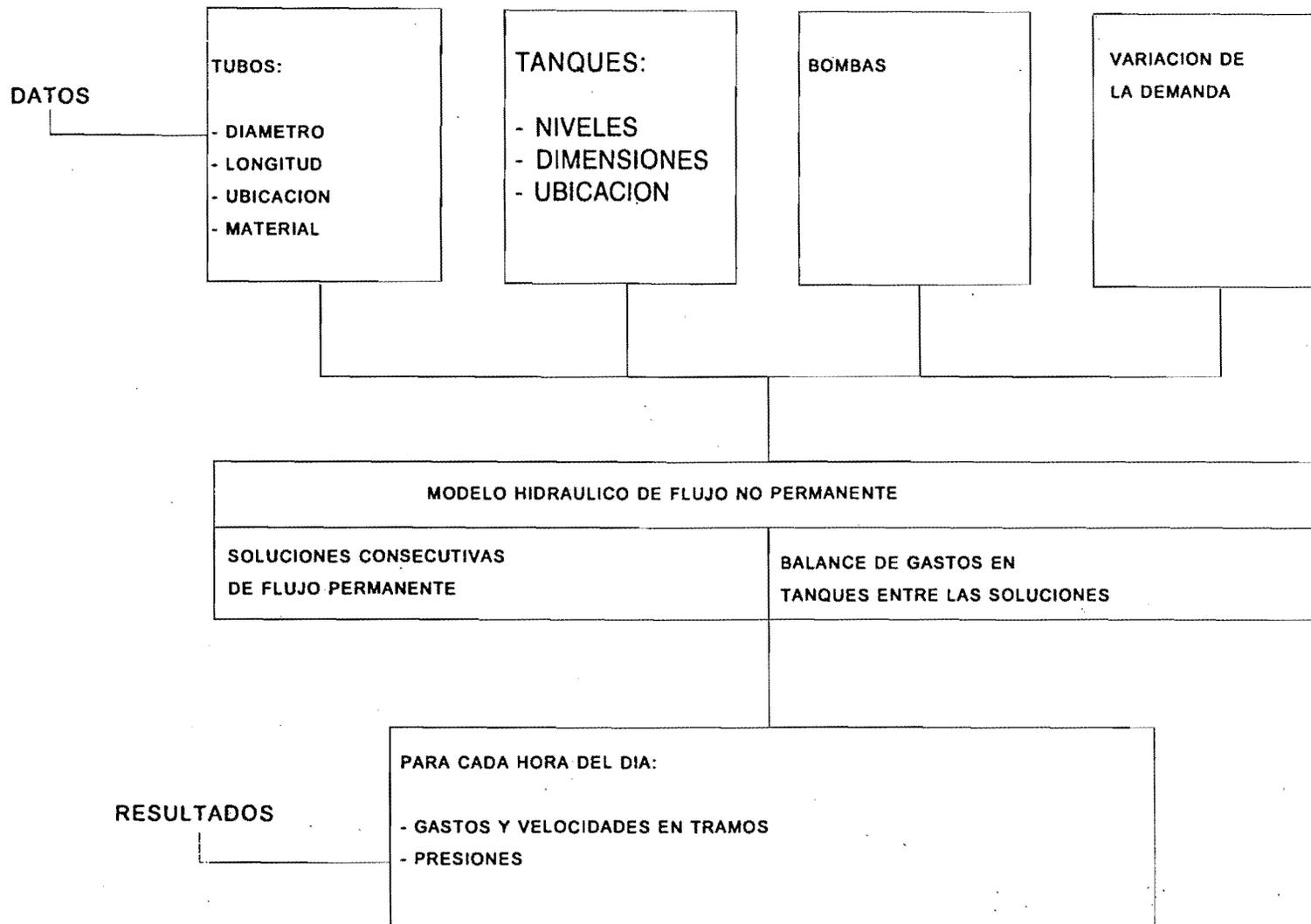
Figura 2.2. Diagrama del modelo hidráulico de flujo no permanente.
