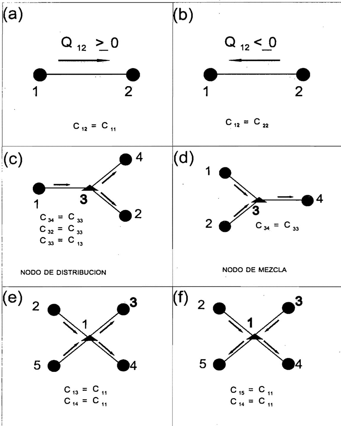
Figura 4.1. Cálculo de las concentraciones en diferentes tipos de nodos
