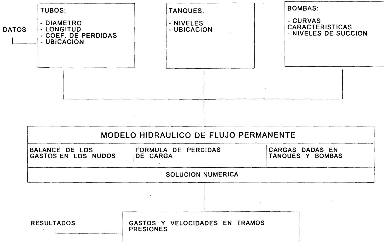
Figura 2.1. Diagrama del modelo hidráulico de flujo permanente.
