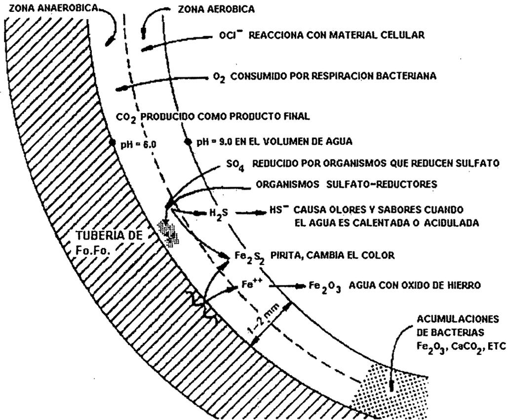
Figura 1.1. Biocapa en un tubo de agua potable
