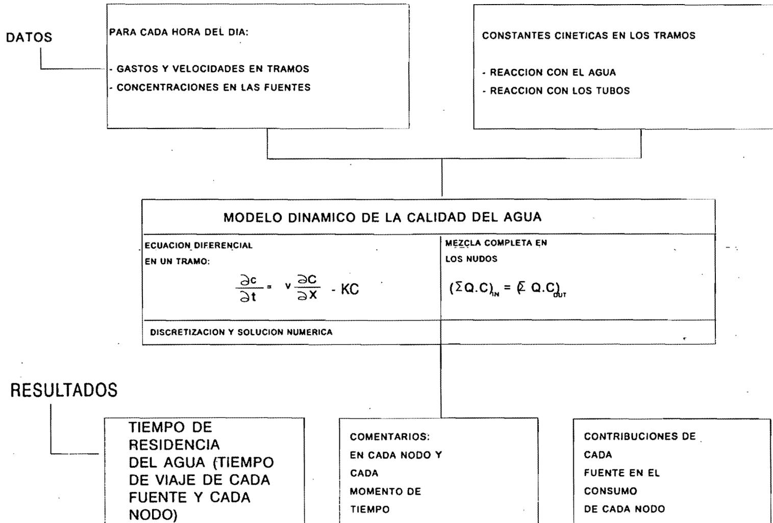
Figura 5.5. Diagrama del modelo de flujo y concentración no permanente.
