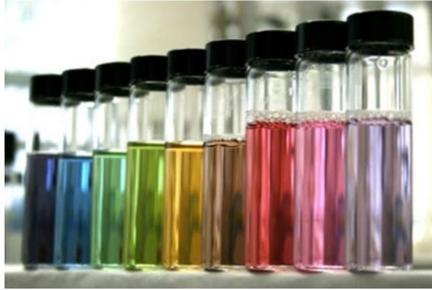
Figura 2.1. La RPS determina el color que se observa en sustancias con NPs metálicas de diferentes tamaños y formas.
