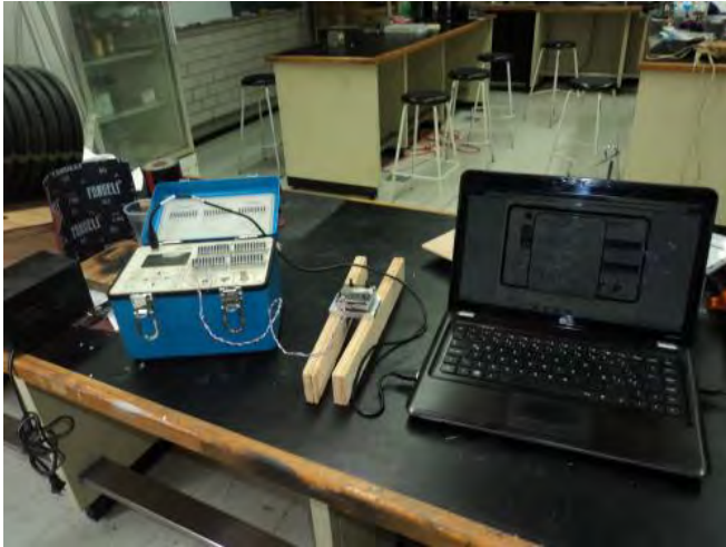
Figura 4.4 Conexión del indicador de microdeformaciones P3 de Micro-Measurement
