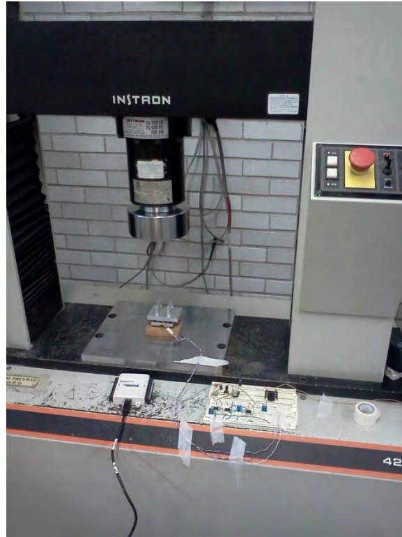
Figura 4.7 Calibración de la celda de carga en la máquina de ensayos Instron.
