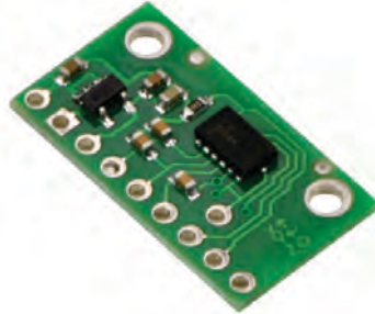
Figura 2.26 Acelerómetro MMA7361L con soporte. (35)
