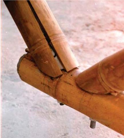
**FOTOGRAFIA N° 56.** Rajadura en las paredes de la Guadua previa a la expulsión del mortero.
