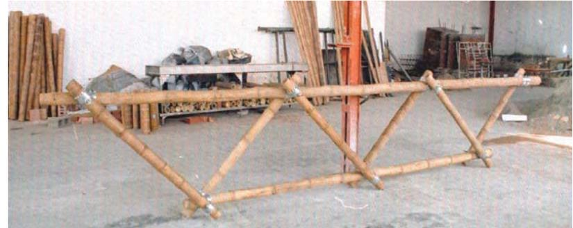
**FOTOGRAFIA N° 14.** Armadura tipo Warren invertido con unión tipo abrazadera.
