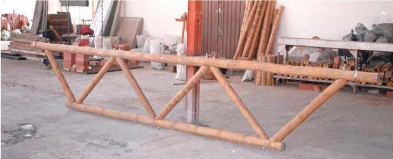
**FOTOGRAFIA N° 21.** Armadura tipo Warren invertido con unión tipo anclaje axial.
