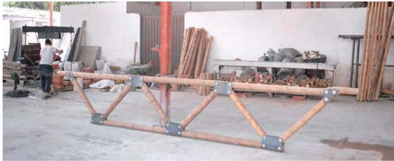
FOTOGRAFIA N° 16. Armadura tipo Warren invertido con unión tipo pletina .
