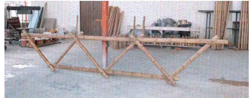
**FOTOGRAFIA N° 10.** Armadura tipo Warren invertido con unión tipo Simón Vélez.
