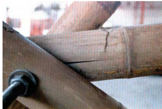
FOTOGRAFIA N° 35. Rajadura a la altura del pasador y posterior aplastamiento en las paredes de la Guadua en la perforación de relleno del cordón superior.
