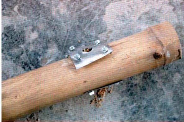
**FOTOGRAFIA N° 41.** Desprendimiento de los tornillos de la pared de la Guadua.
