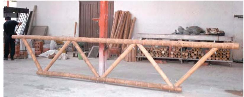
FOTOGRAFIA N° 19. Armadura tipo Warren invertido con unión tipo ancla e.
