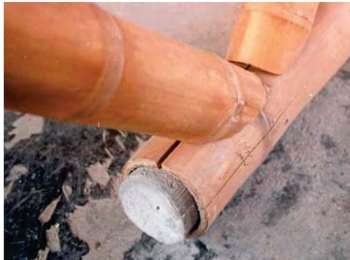
**FOTOGRAFIA N° 57 y 58.** Expulsión del mortero del cordón inferior.
