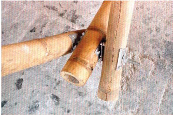
**FOTOGRAFIA N° 42.** Desprendimiento de los tornillos de la pared de la Guadua.
