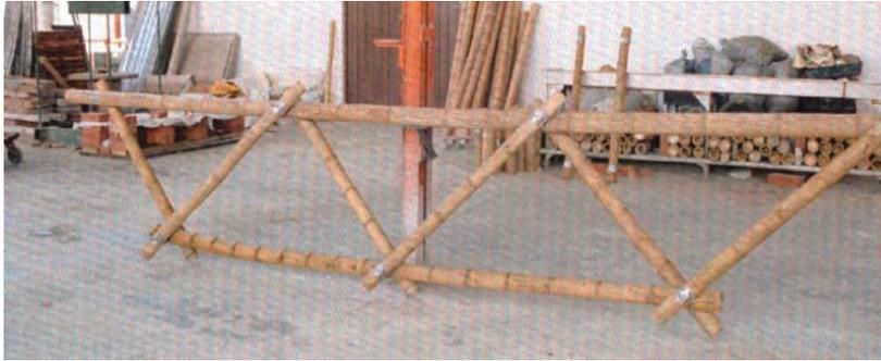
**FOTOGRAFIA N° 12.** Armadura tipo Warren invertido con unión tipo mecánica modificada.
