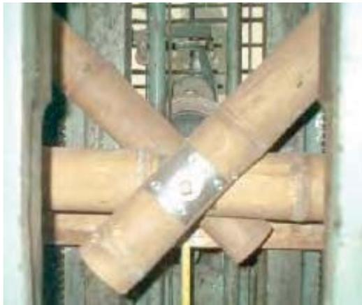
**FOTOGRAFIA N° 13.** Detalle unión tipo mecánica modificada.
