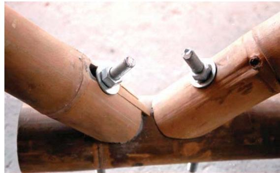
**FOTOGRAFIA N° 54.** Rajadura en las paredes de la Guadua de elemento diagonal a tensión.
