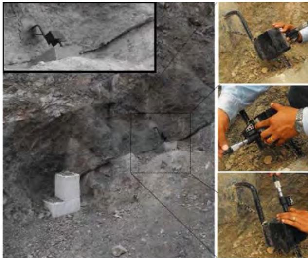
Figura 4.6. Medición de juntas tridimensionales.
