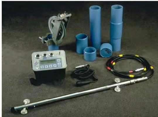
Fotografía 4.5. Equipos utilizados en mediciones de inclinometría.
