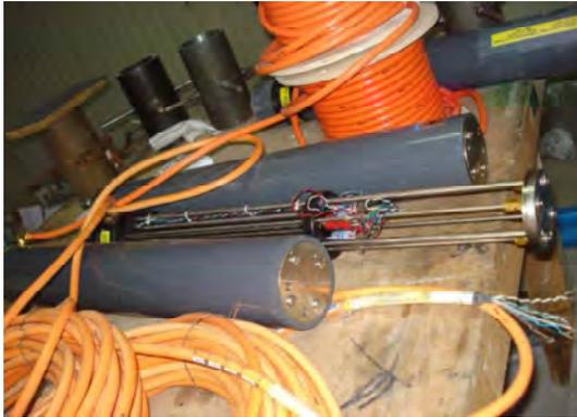
Fotografía 4.1. Extensómetro de barra.
