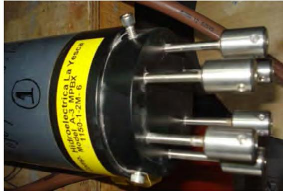
Fotografía 4.2. Cabezal de extensómetro de barras.
