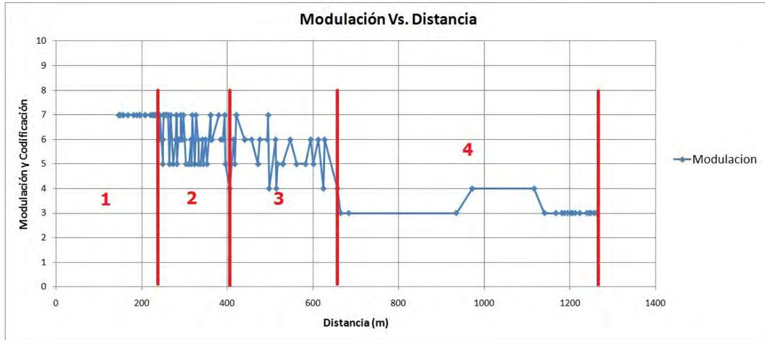
**Figura 6.5: Secciones según la Modulación y tasa de codificación.**
