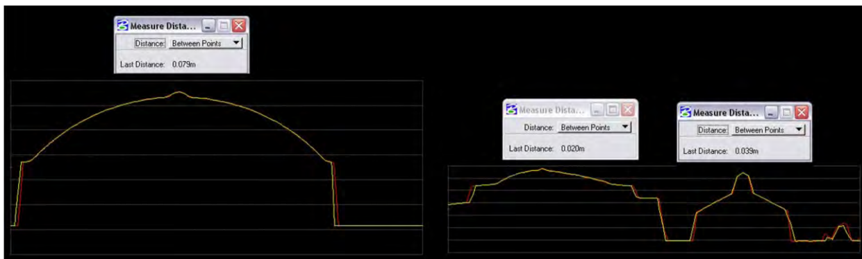
Imagen 4.31. Comprobación de corrección de error por cabeceo
