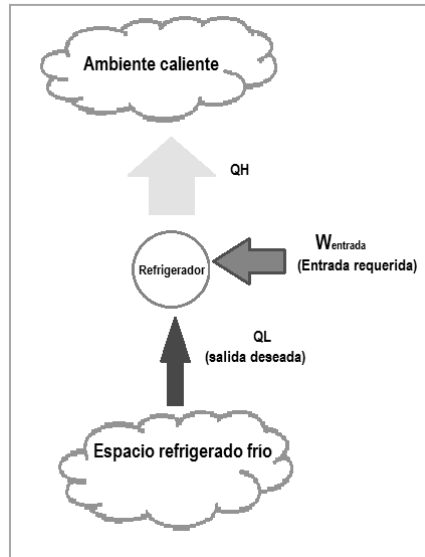
Figura 3.14 Refrigerador de Carnot
