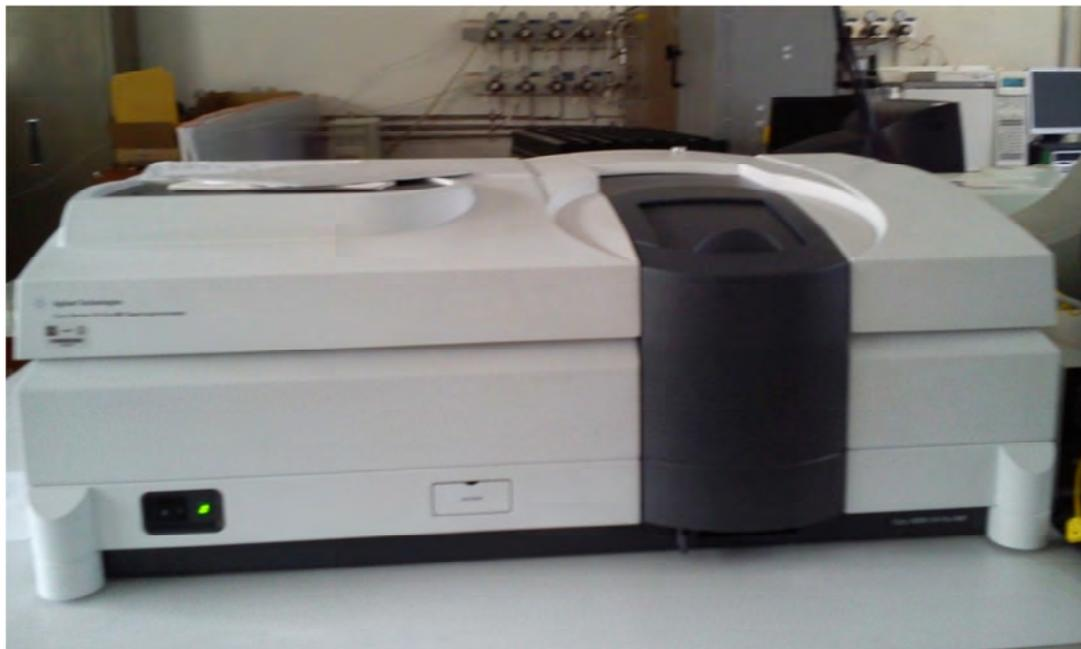
*Figura 4.4* Espectrofotómetro de doble haz, UV - VIS-NIR Cary 5000 (Varian)
